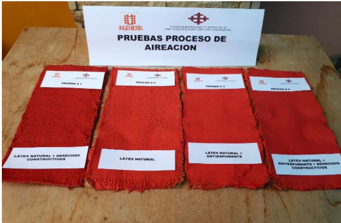
Figura 51. Pruebas de las mantas impermeabilizantes naturales expuestas a la intemperie.
