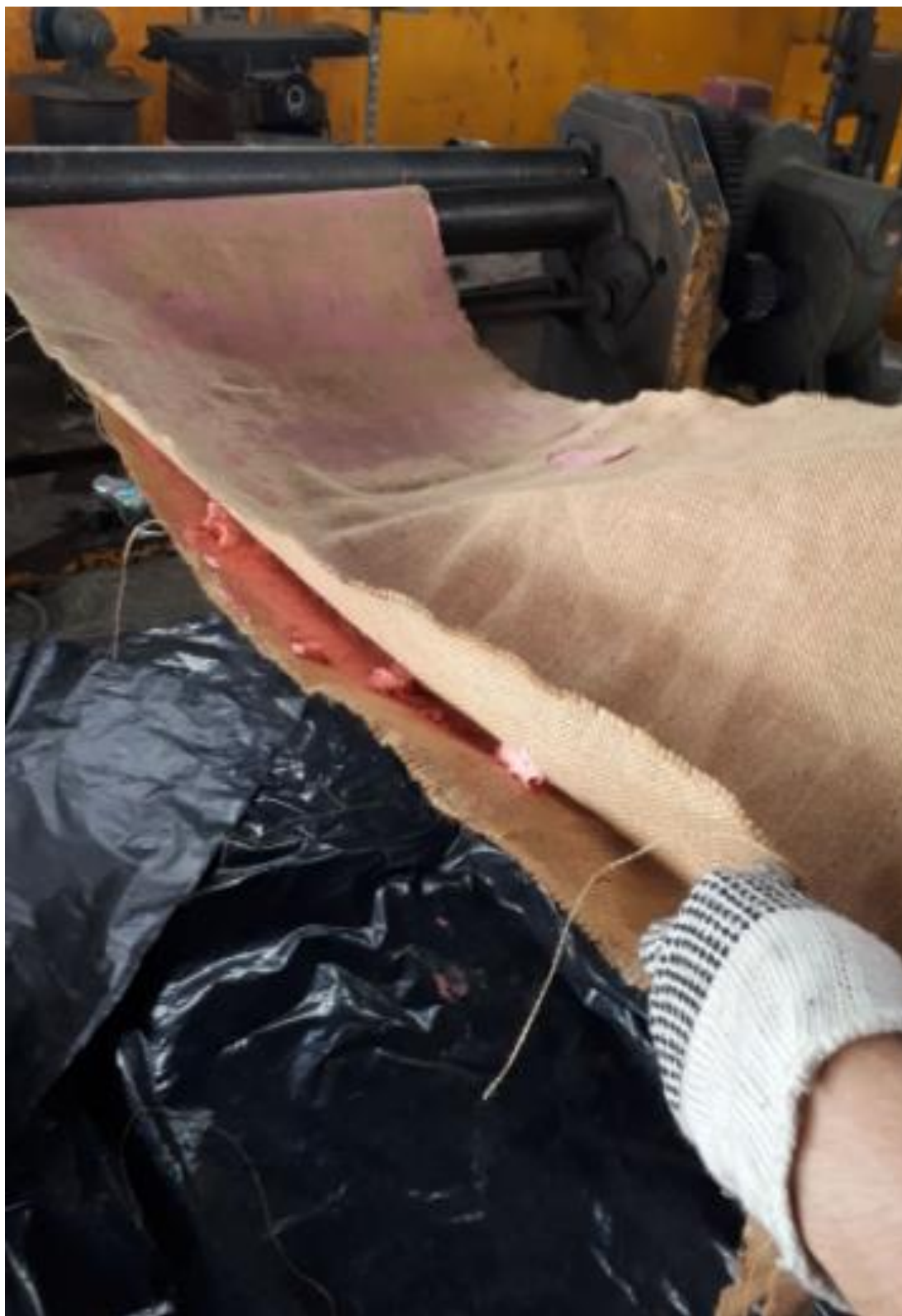
Figura 57. Colocación de la mezcla de Látex natural con desechos de construcción en el tejido natural.
