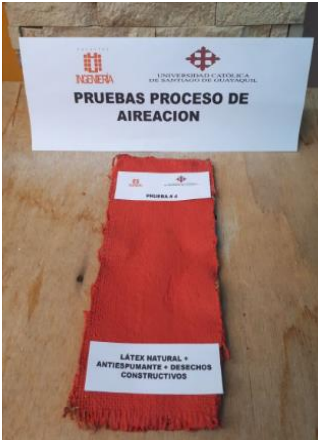
Figura 50. Prueba # 4 Látex natural + Desecho constructivo + Antiespumante.
