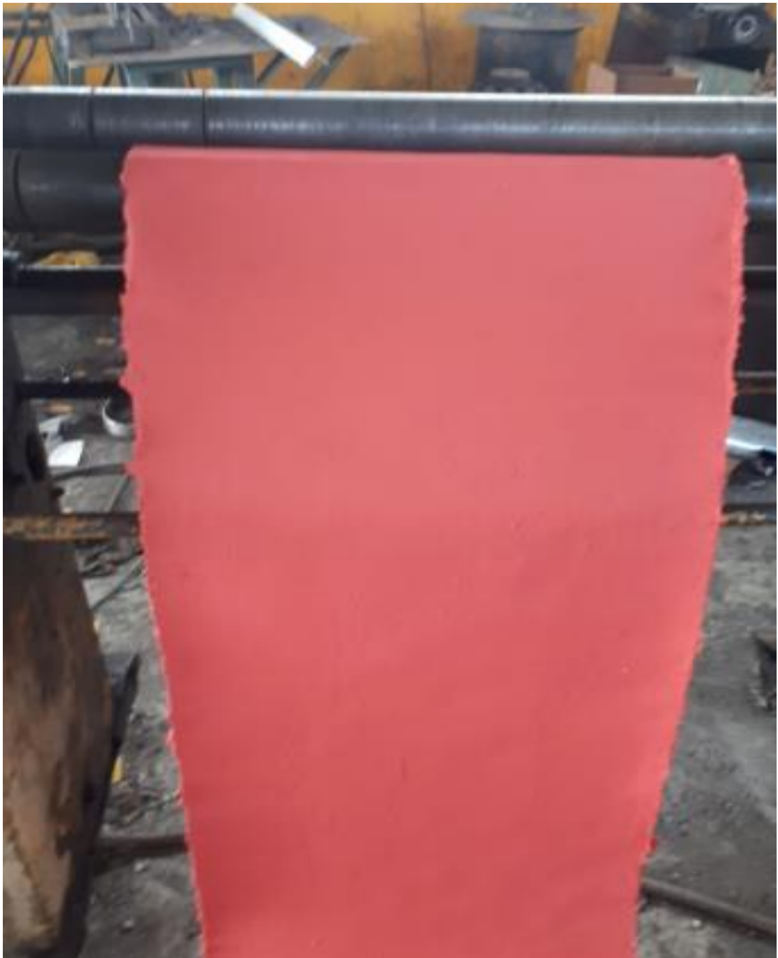
Figura 55. Proceso de compactación del Látex natural con Desechos de construcción y tejido natural.
