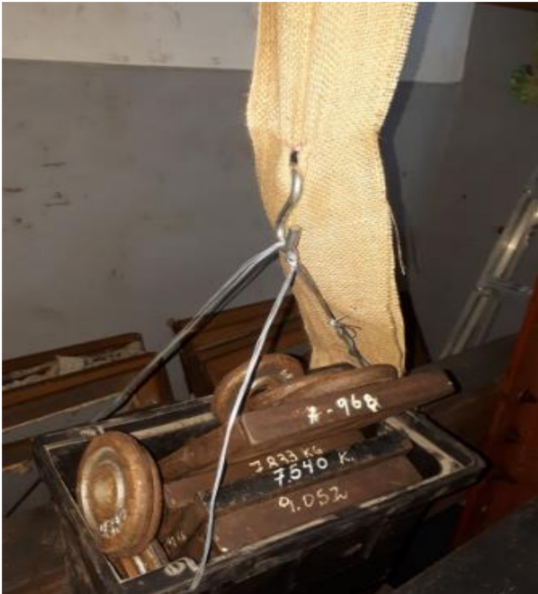
Figura 71. Ensayo de resistencia al desgarro.
