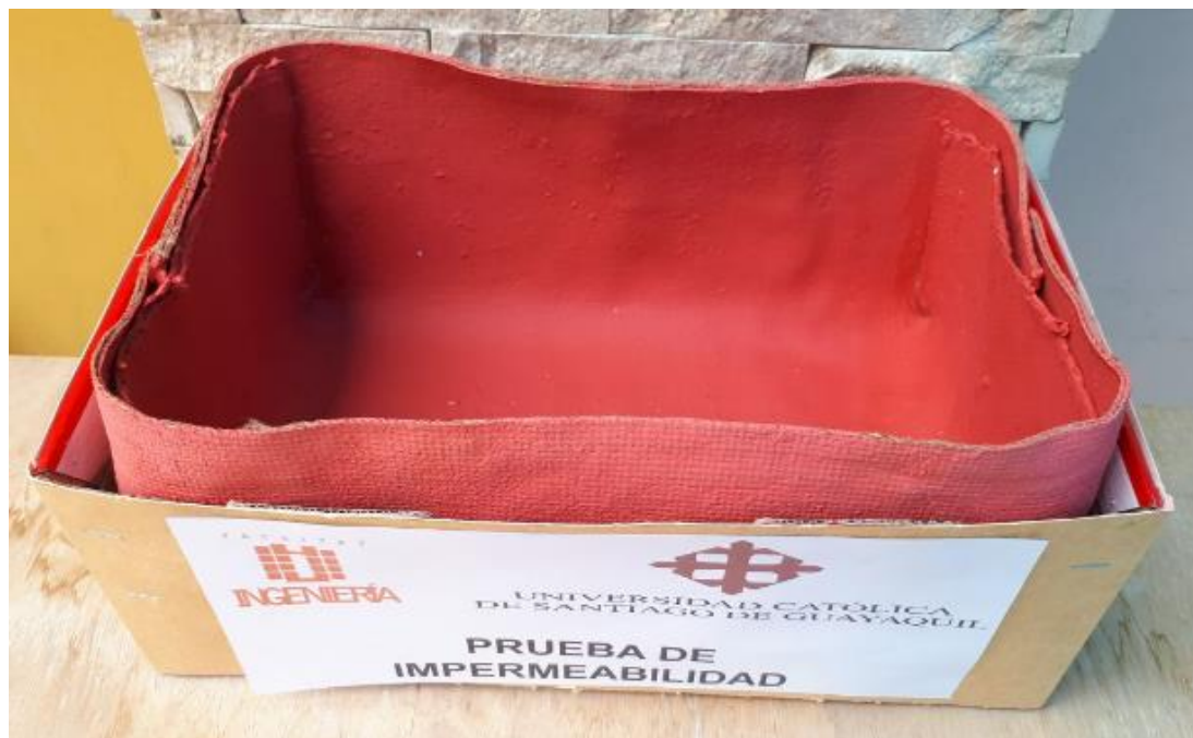
Figura 72. Ensayo de impermeabilidad en la manta impermeabilizante natural.
