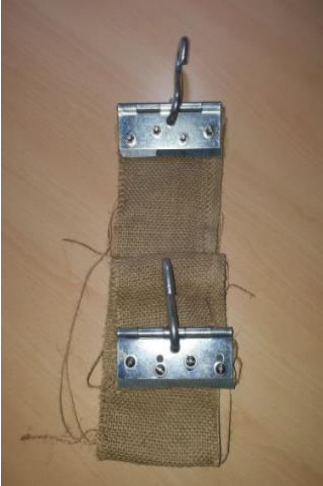
Figura 67. Tira de yute para ensayo resistencia a la tensión.
