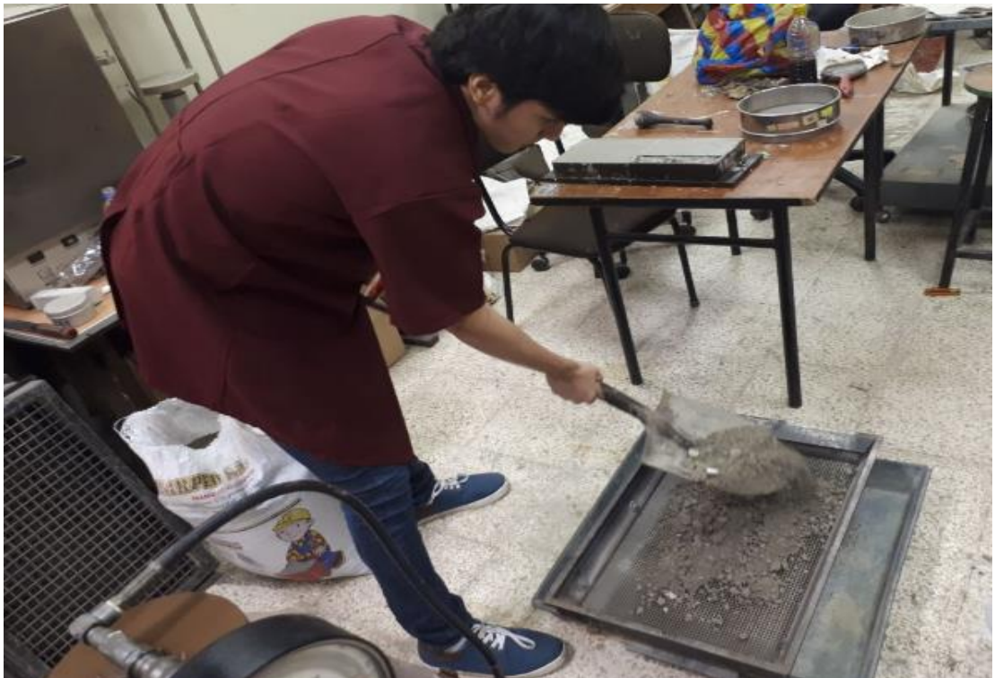
Figura 33 Proceso de tamizaje.
