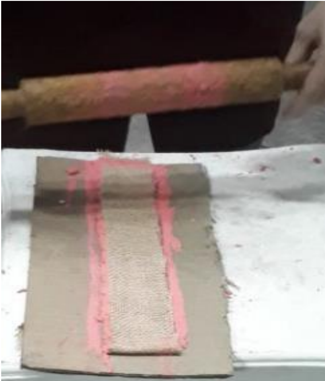
Figura 46. Manta realizada con Látex natural + polvo de desecho constructivo + Antiespumante.
