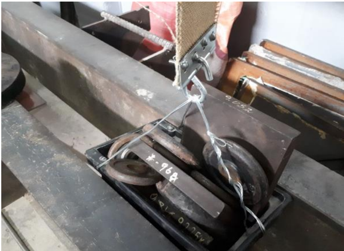
Figura 69. Ensayo de resistencia a la tracción.
