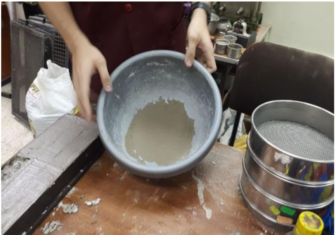
Figura 36 Proceso de tamizaje por tamiz #60 ASTM.
