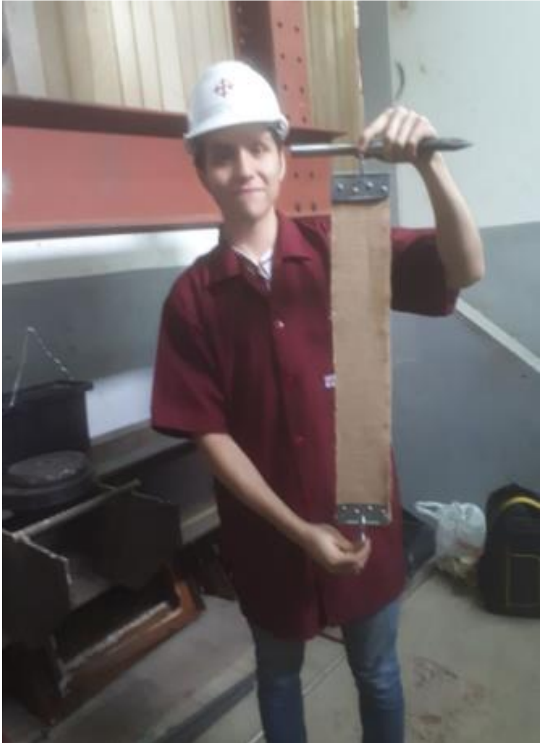
Figura 66. Tira de yute para ensayo resistencia a la tensión.
