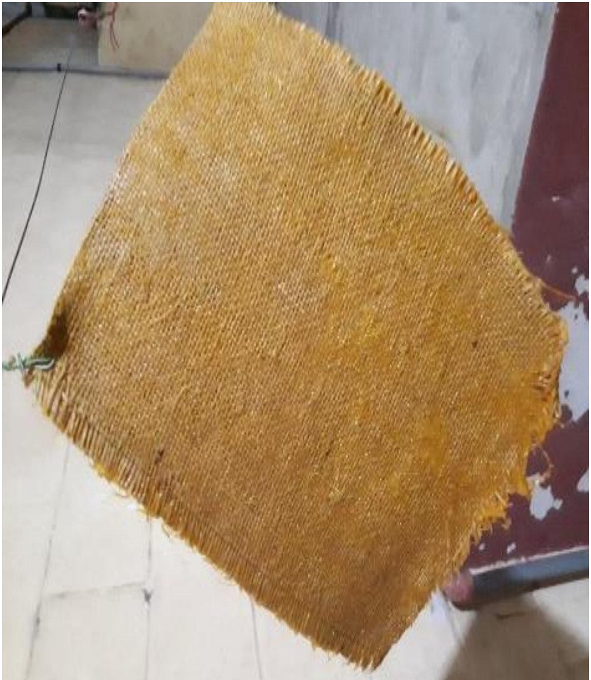
Figura 29 Secado de la simulación del proceso de impermeabilización utilizando productos orgánicos naturales.
