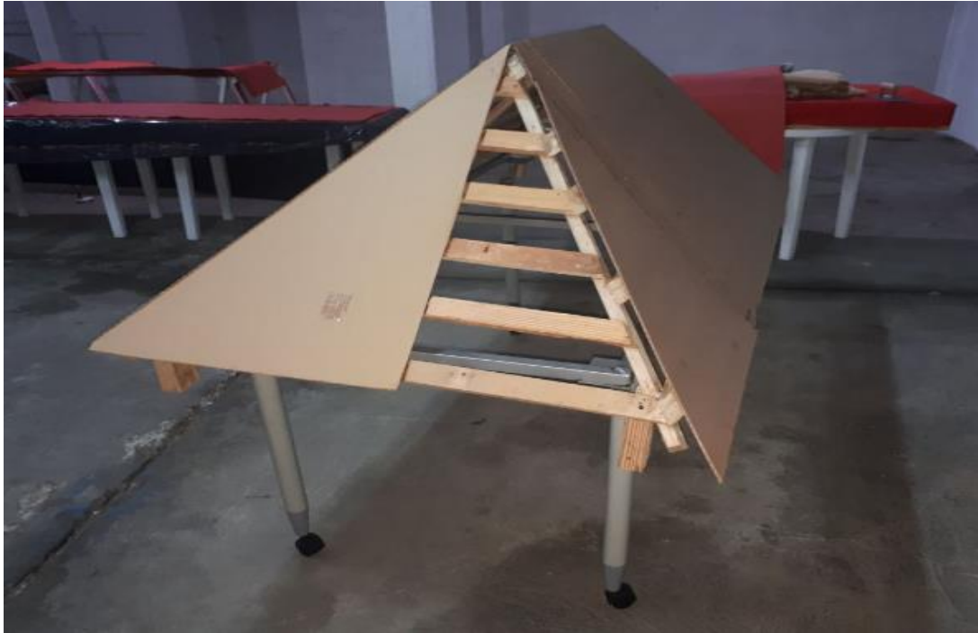
Figura 63. Cubierta desmontable de simulación forrada con cartón.
