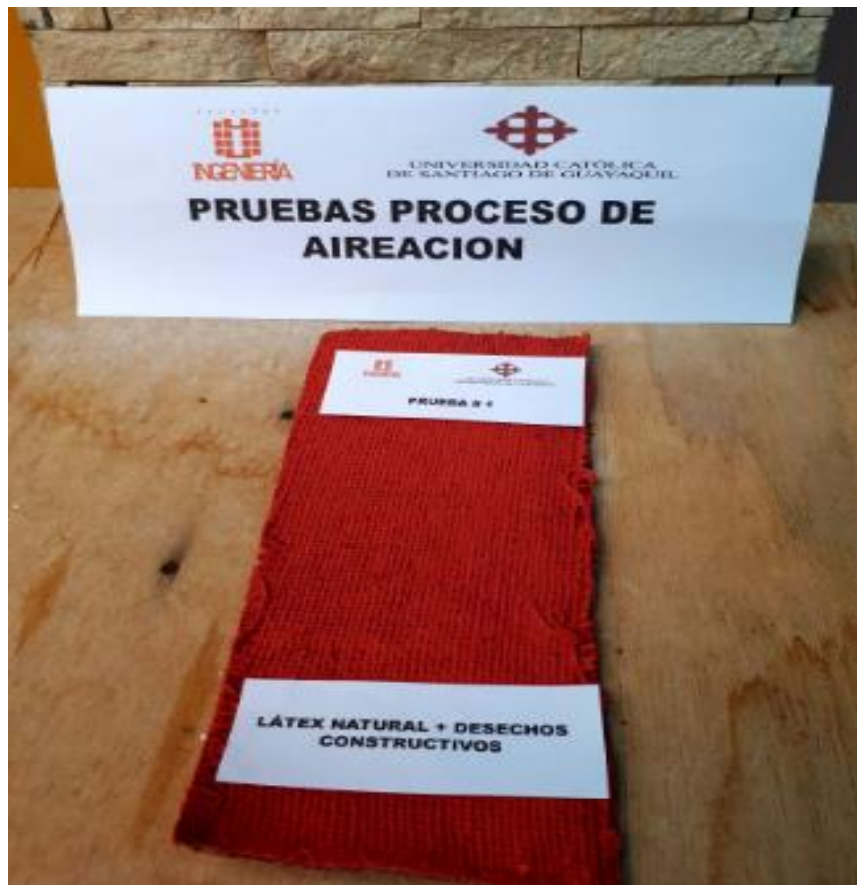
Figura 47. Prueba # 1 Látex natural + Desecho constructivo.
