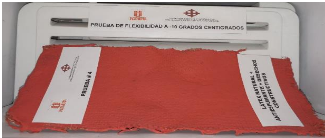
Figura 74. Ensayo de flexibilidad a -10 grados centígrados.
