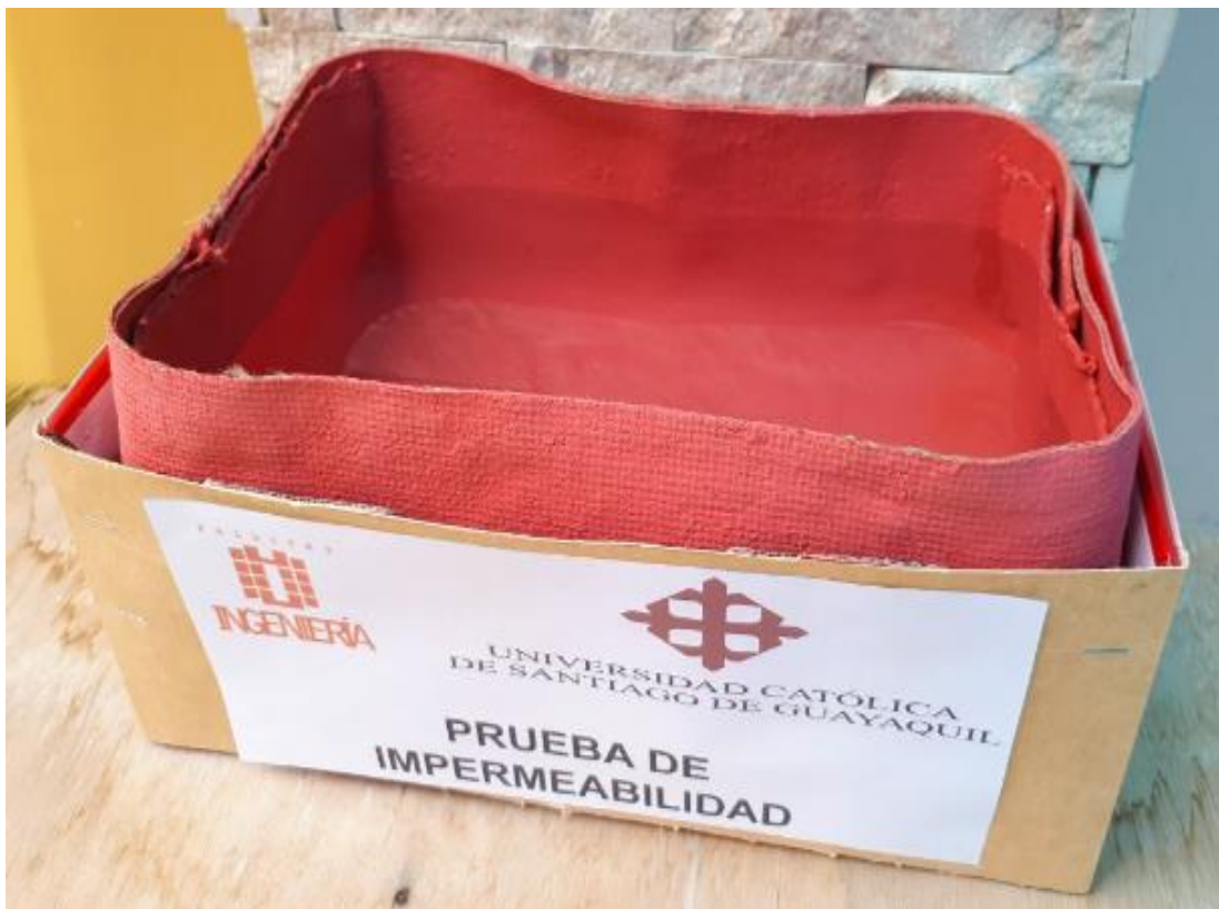
Figura 73. Ensayo de impermeabilidad en la manta impermeabilizante natural.
