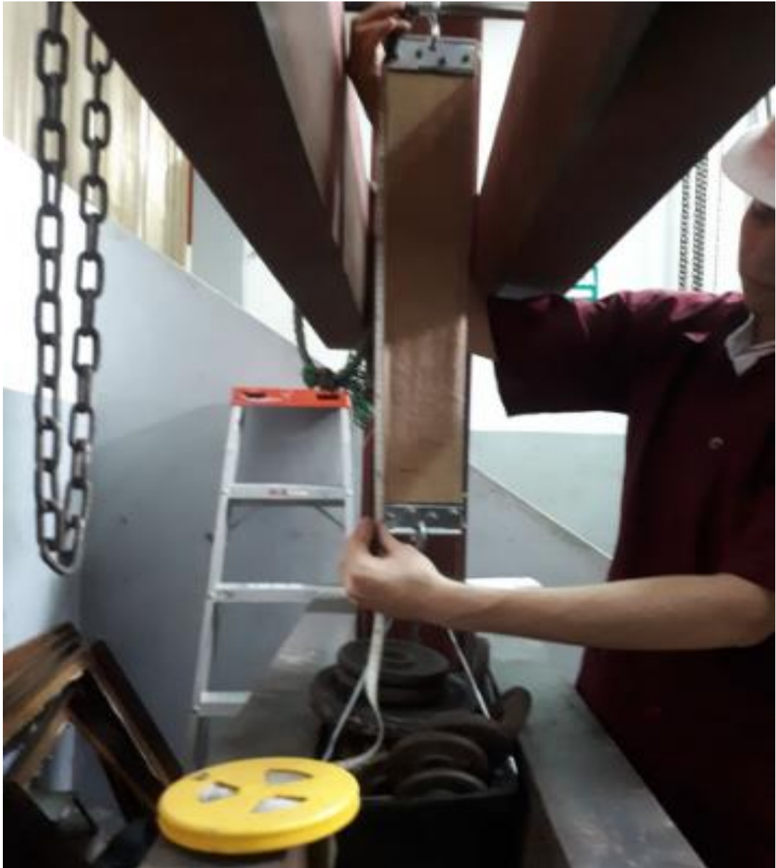
Figura 70. Ensayo de elongación.
