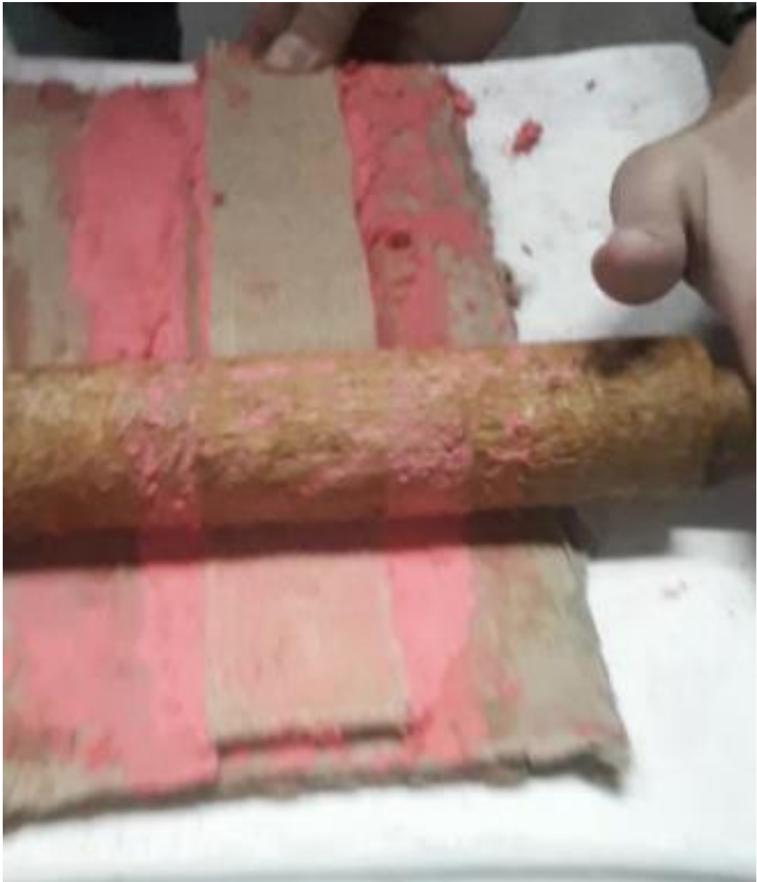
Figura 45. Manta realizada con Látex natural + Antiespumante.
