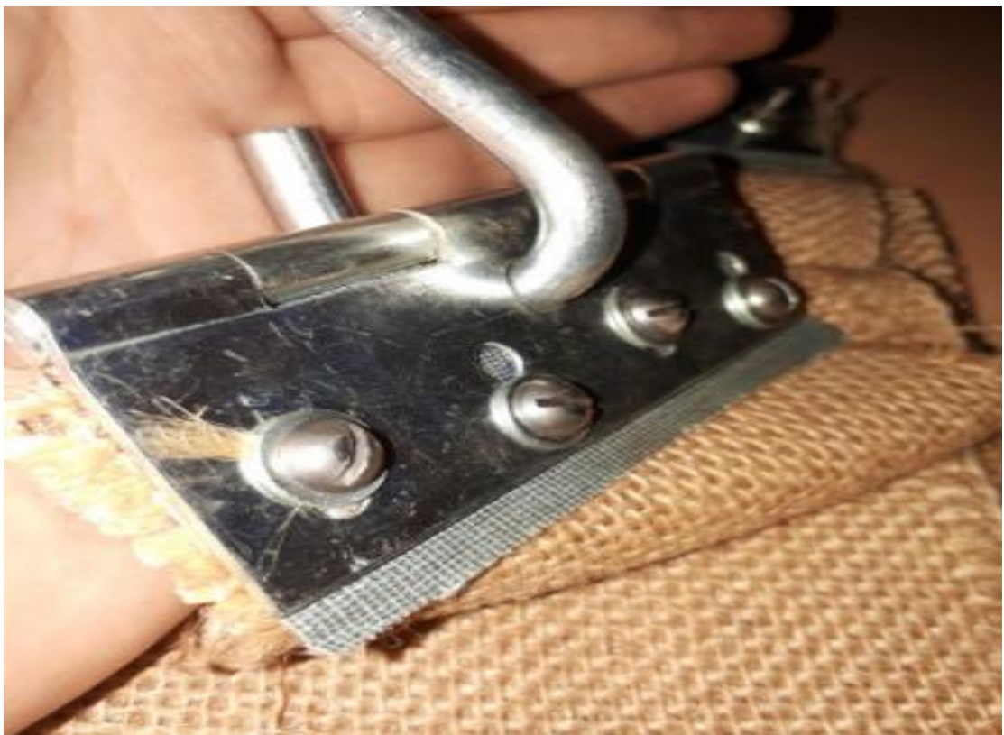
Figura 68. Modo de sujeción para ensayo resistencia a la tensión.
