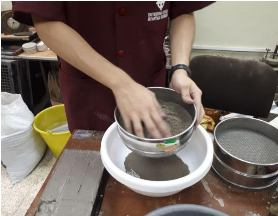
Figura 35 Proceso de tamizaje por tamiz # 60 ASTM.
