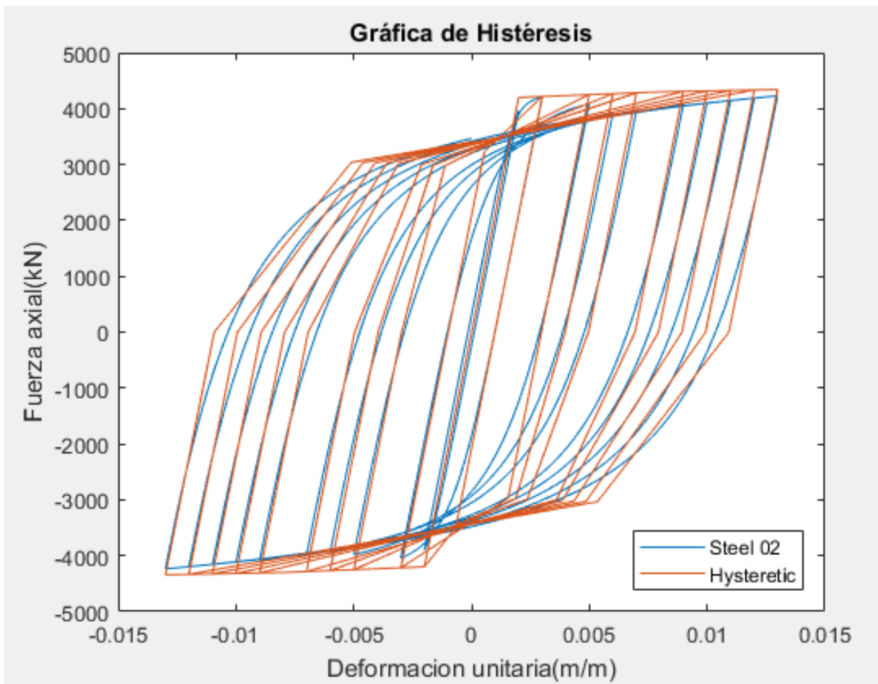
Ilustración 14 Calibración del modelo, Hysteretic material al Steel 02.
