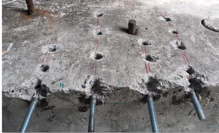
**Ilustración 12.** Perforaciones realizadas para la medición de temperatura, con las guías respectivas.
