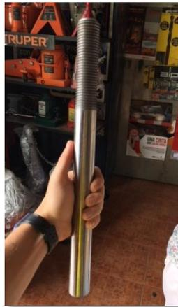
***Ilustración 27.*** Varilla de 32 mm con rosca de 12 cm de largo.
