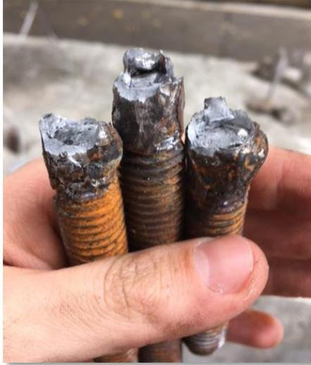
***Ilustración 31.*** Varillas ensayadas con soldadura.
