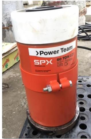
**Ilustración 25.** Gato Hidráulico Power Team de 60 Ton.
