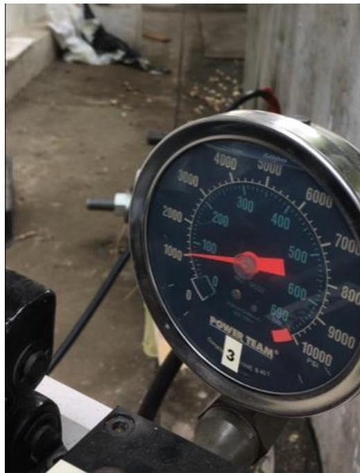
*Ilustración 51.* Monitoreo de la lectura de presión para ensayos a tracción (anclaje 5, parte inferior del macizo de hormigón).
