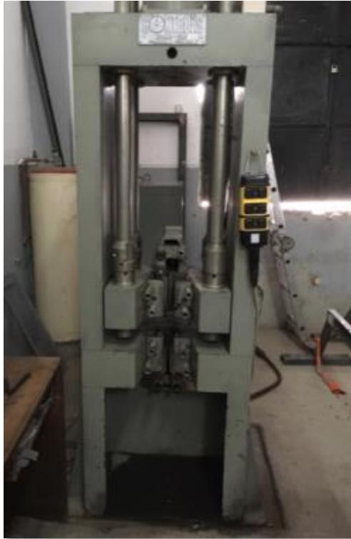
***Ilustración 44.*** Máquina para ensayos a tracción CONTROLS.
