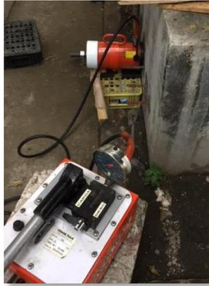
**Ilustración 29.** Nivelación del gato y ubicación de la máquina que ejerce fuerza.
