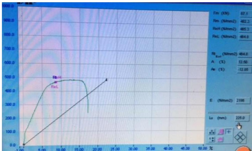
**Ilustración 48.** Diagrama de esfuerzo vs deformación (%), y resultado de la fuerza de fallo.
