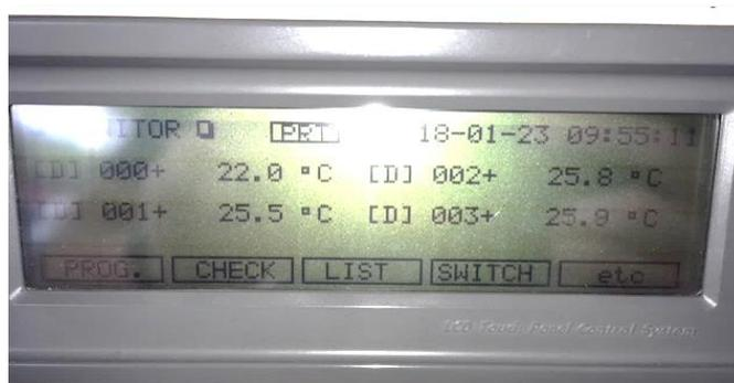
**Ilustración 35.** Lectura de temperaturas en 4 puntos (anclaje de 40cm Prof.)
