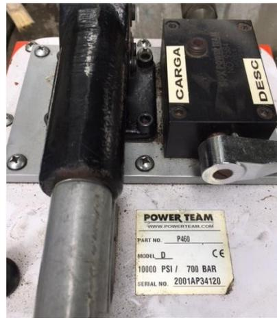
**Ilustración 26.** Máquina Power Team que ejerce la fuerza para el funcionamiento del Gato hidráulico.
