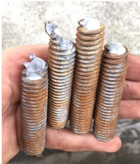
***Ilustración 32.*** Varillas sin soldar ensayadas.
