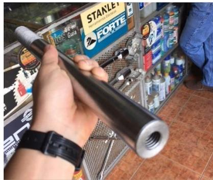
***Ilustración 28.*** Hueco de 5 cm de largo con hilos para varillas de 16 mm.
