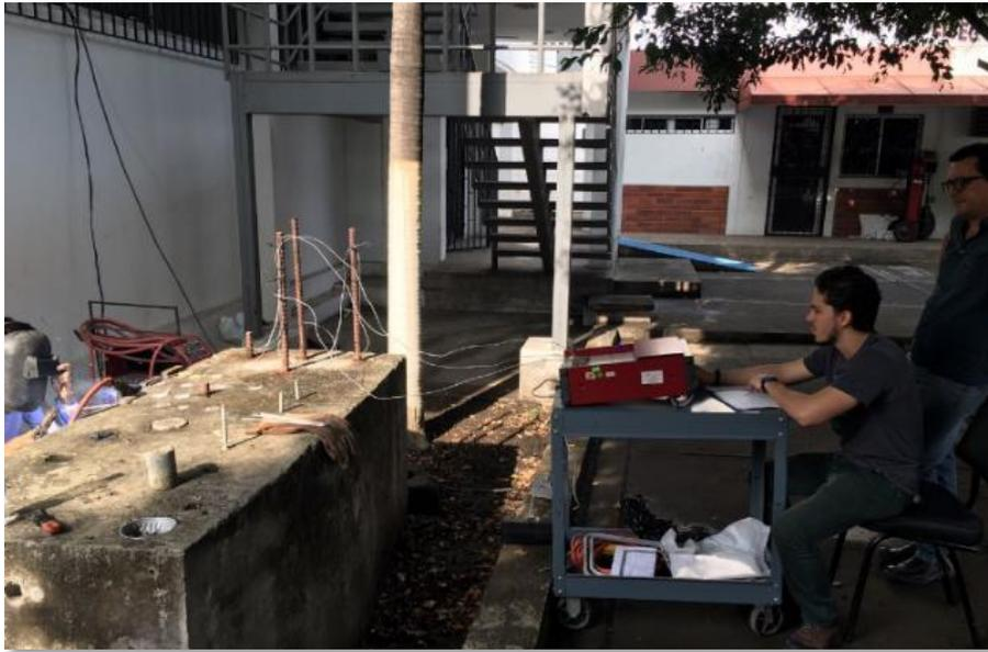
*Ilustración 50.* Monitoreo de temperatura para los anclajes químicos.
