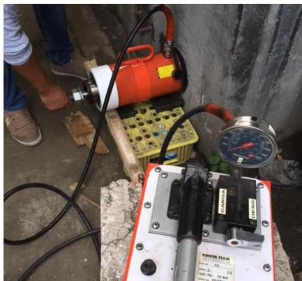
**Ilustración 30.** Sistema varilla-tuerca-anillo empujado por el pistón del gato hidráulico.
