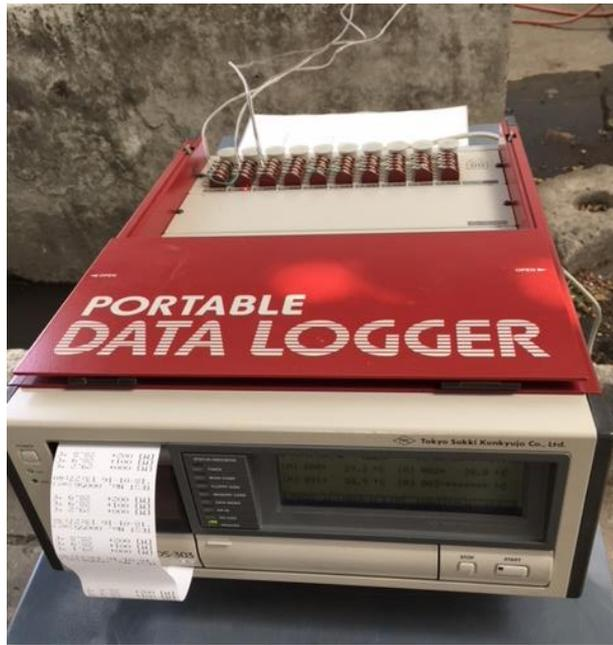
**Ilustración 19.** Máquina DATA Logger para registrar mediciones de temperatura.
