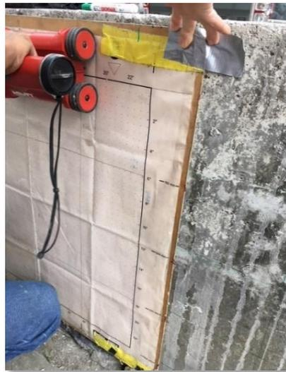
**Ilustración 6.** Base con medidas guía para el Ferroskan.
