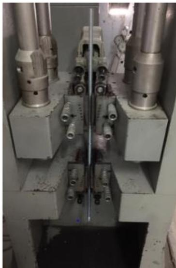
***Ilustración 45.*** Varilla de 16 mm lista para el ensayo.
