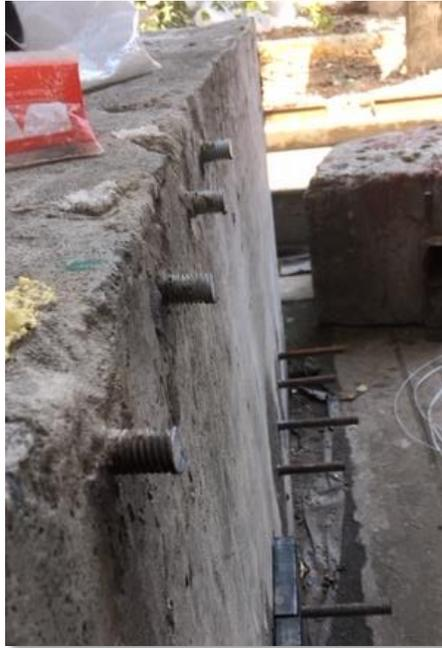
**Ilustración 21.** Varillas de anclajes químicos para prueba de temperatura cortados.
