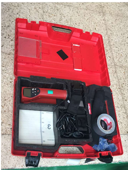
Figura 8. Ferroskan PS200 HILTI de la UCSG
