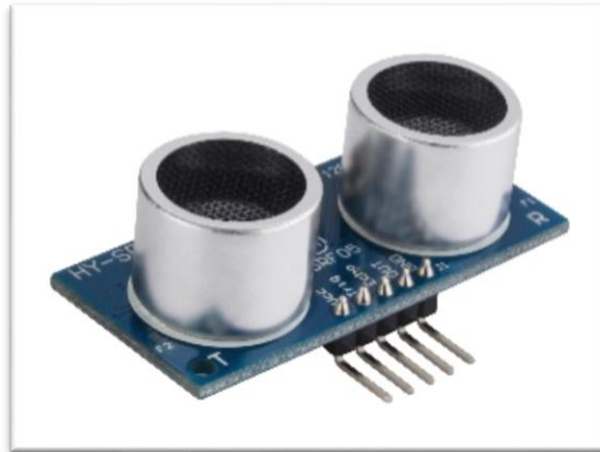
Figura 3. 11 Sensor ultrasónico HCSR04. Fuente: (ARDUINO, 2018)
