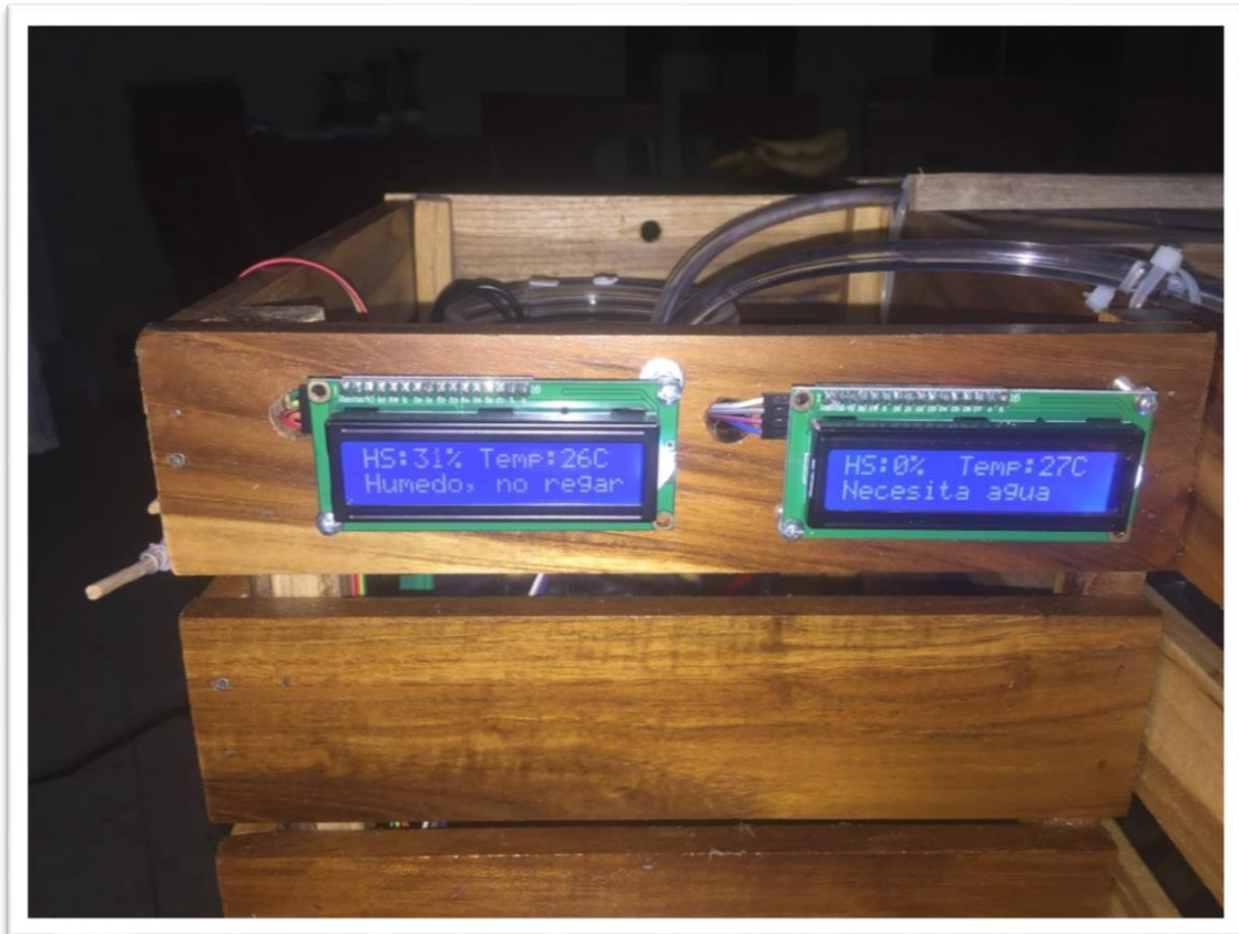
Figura 5. 1 HMI del sistema de riego. Elaborado por: Autor.
