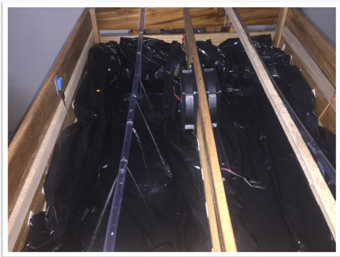
Figura 5. 2 Sistema de riego de la maqueta en respuesta al sensor FC-28. Elaborado por: Autor
