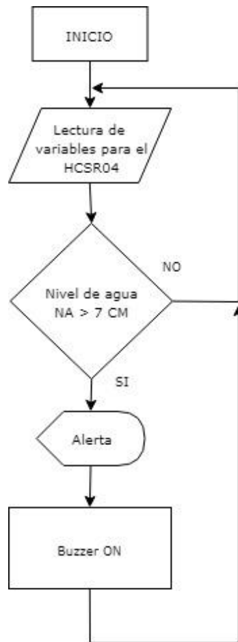
Figura 3. 4 Diagrama de flujo del sistema de alerta. Elaborado por: Autor
