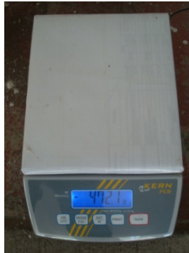
Imagen 2 Balanza de precisión de 0.01gr
