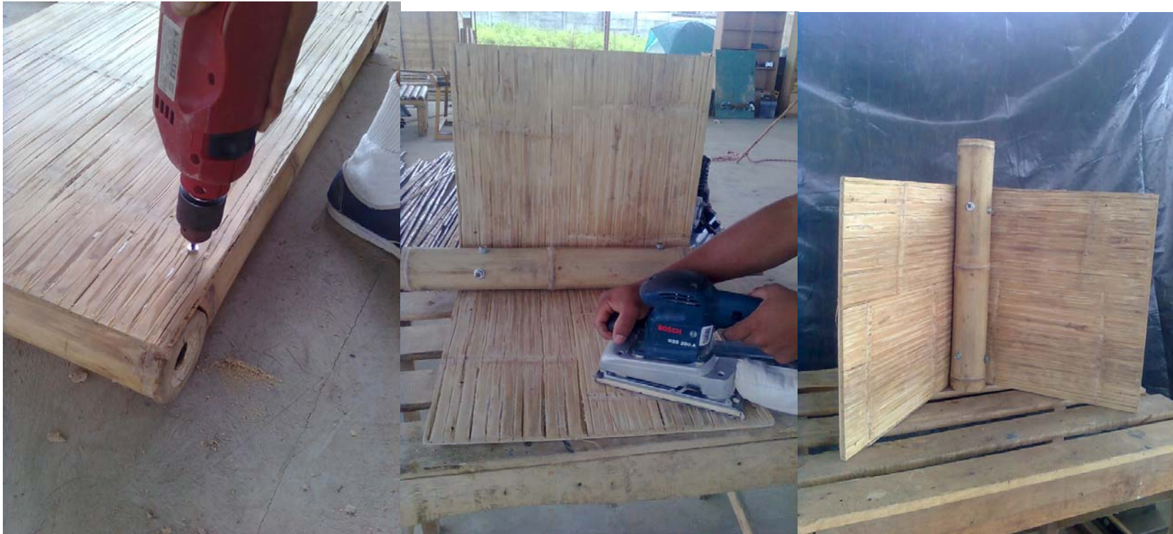
Detalle de unión en "L" realizado con Ecu-Bam C003
