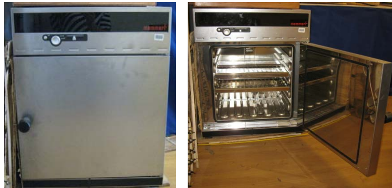
Imagen 3 Horno tipo SNB con capacidad de 220°C
