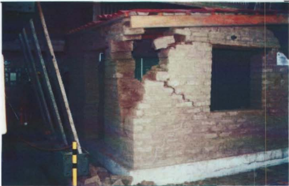
Foto 34. Daño en esquina reproducido en ensayo dinámico de un módulo sin refuerzo. Foto: COPASA-GTZ-PUCP
