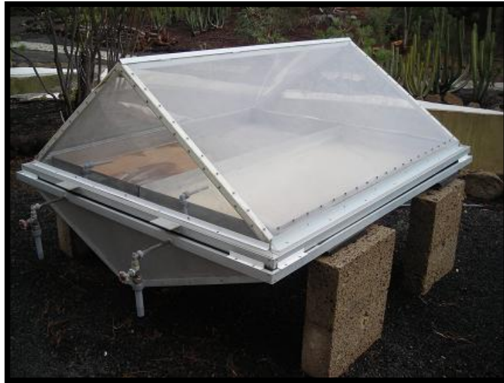
Ilustración 9. Destilador solar de dos vertientes.
