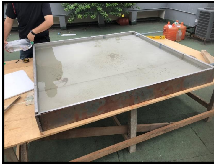
Ilustración 30. Bandeja secundaria con 150 litros de agua.
