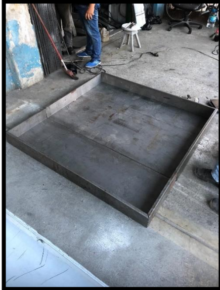
Ilustración 17. Bandeja primaria de acero negro.
