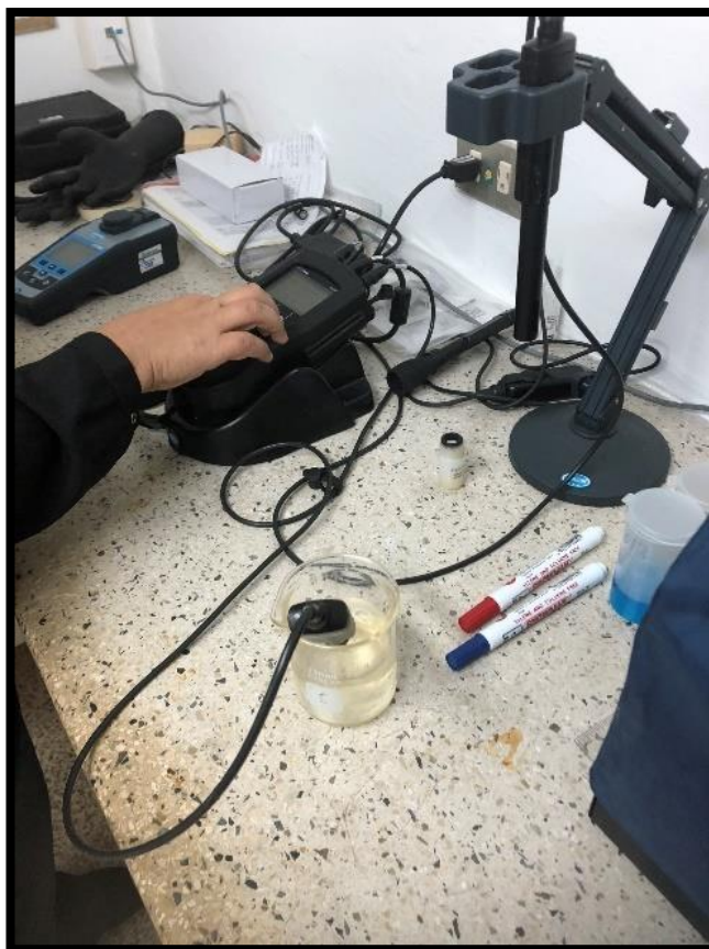
Ilustración 40. Equipo para medir el pH de la muestra de agua
