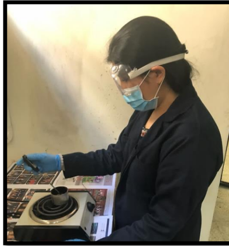
FIGURA 2. 8 Toma de temperatura al asfalto base y rejuvenecedor Sylvaroad RP1000
