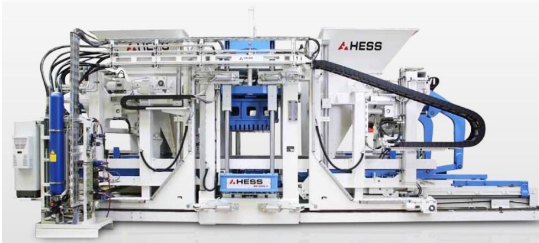
Figura 23. Máquina para la producción de concreto marca HESS modelo RH2000 Nota: Los datos fueron obtenidos del catálogo de maquinarias HESS, 2018
