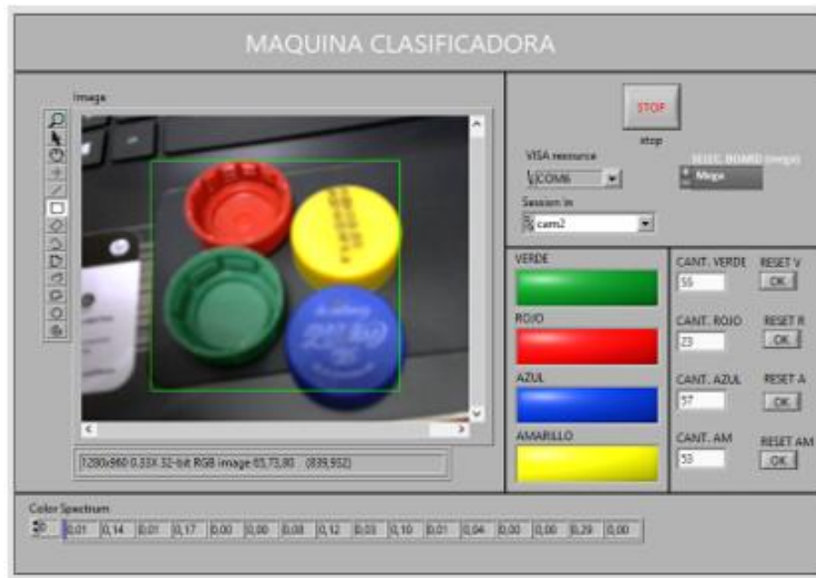
Figura 3. 28: Interfaz de usuario de la aplicación de la planta clasificadora Elaborado por: Autor
