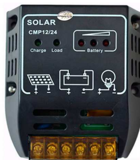
Figura 11. Controlador de carga solar. Fuente: Elaboración propia.
