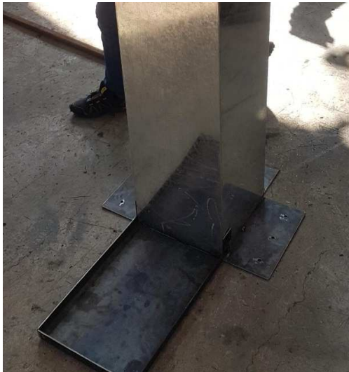
Figura 18. Bases en acero negro del equipo. Fuente: Elaboración propia.
