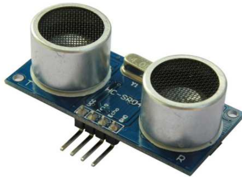
Figura 3. Sensor Ultrasónico HC-SR4. Fuente: (Solace Labs, 2015).
