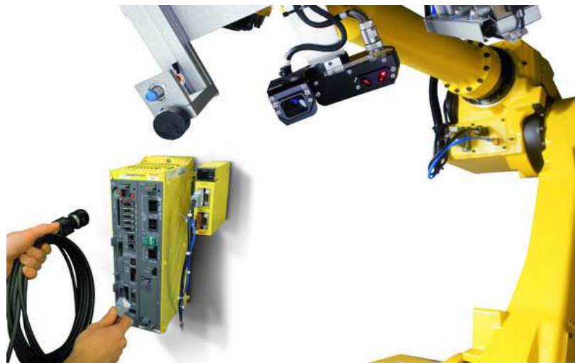
Figura 2. 26 Brazo robot con sistema visión láser (comunicación por RS232 y Ethernet)
