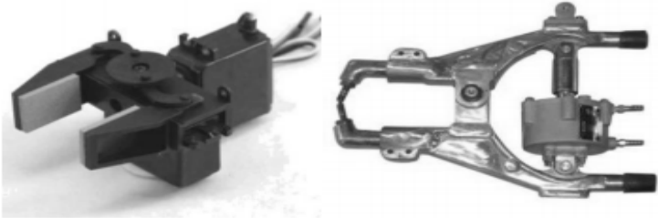
Figura 2. 15 Pinza y herramienta robóticas (soldadura por puntos)
