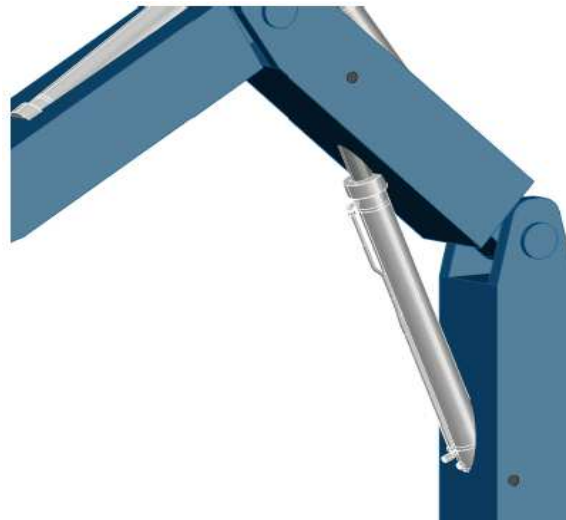
Figura 3. 6 Vista de cilindro doble efecto del manipulador
