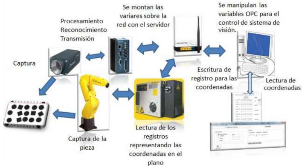
Figura 2. 25 Proceso de comunicación básico entre un manipulador y sistema de registro basado en OPC
