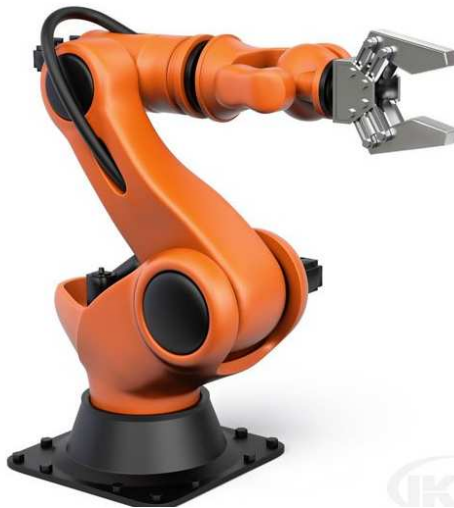
Figura 2. 4 Brazo manipular con accionamiento eléctrico en ejes
