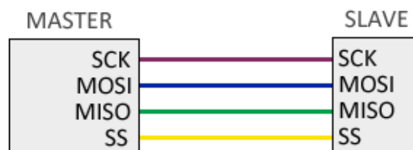
Figura 2. 25: Bus Serial Peripheral Interface (SPI) Fuente:(LLamas Luis, 2016)
