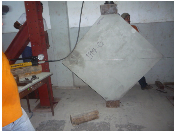
- 9. Pórtico de reacción -
