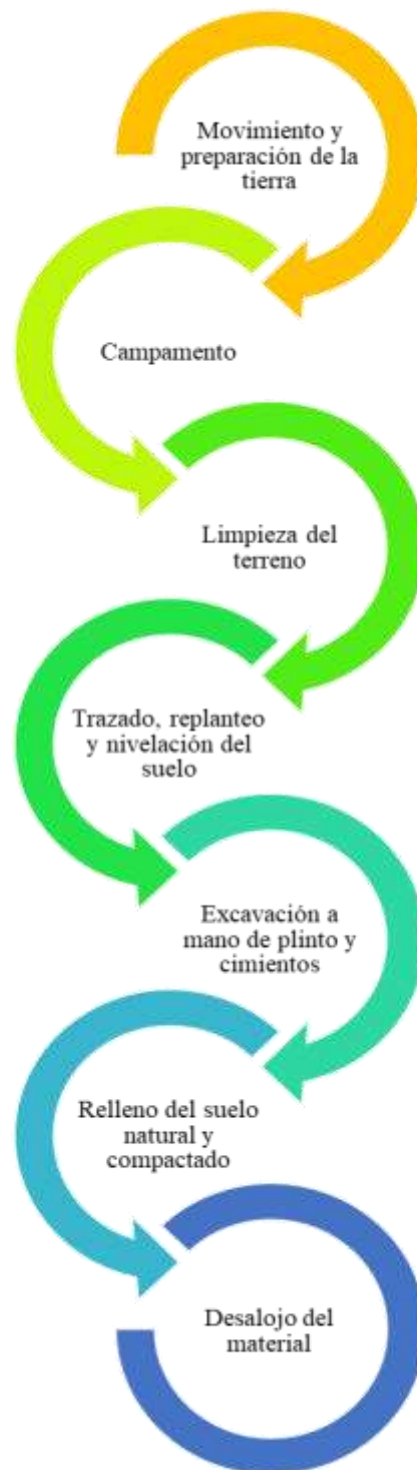
Figura 35. Proceso de construcción de la vivienda
