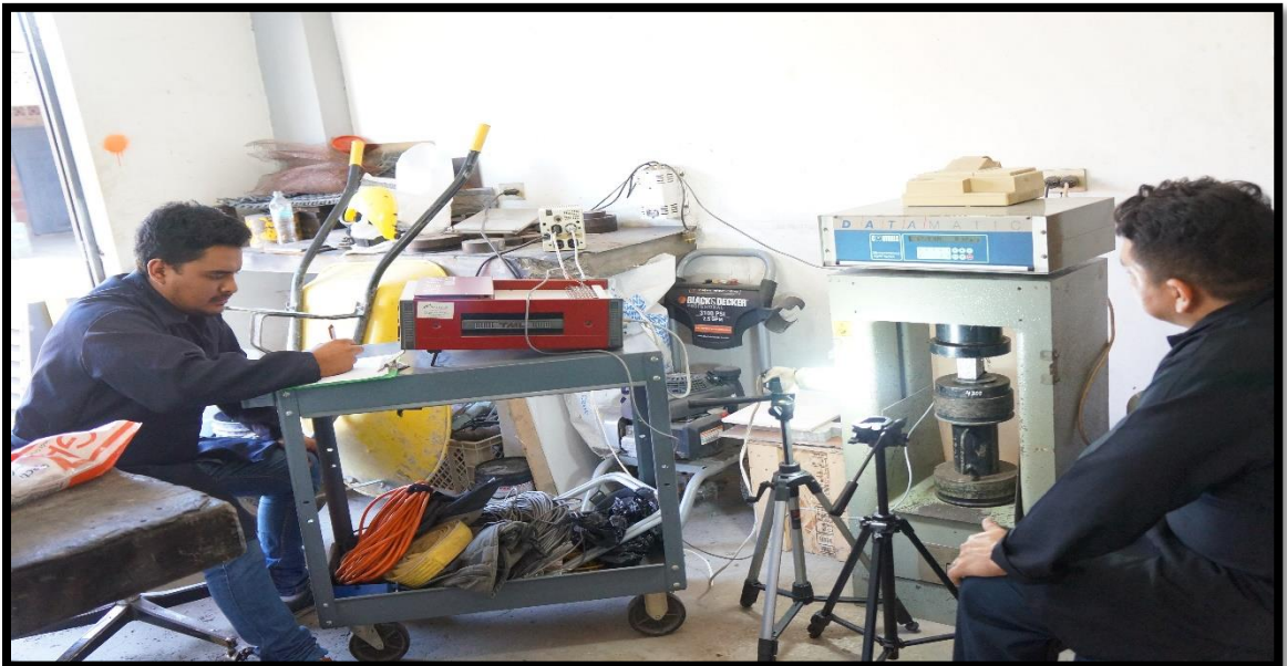
Figura 4A Ubicación de los elementos durante el ensayo de probetas de hormigón.
