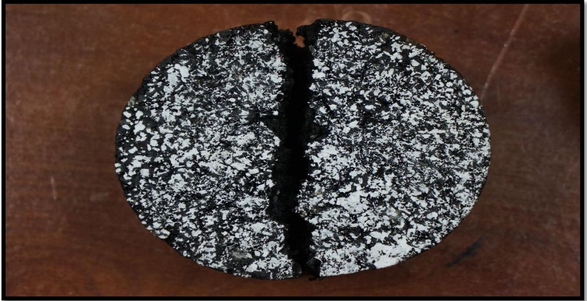
Figura 5A Briqueta llevada a su falla, mediante el ensayo de la máquina del N.A.T.
