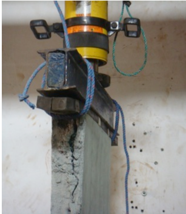
Ilustración 47: Inicio de la falla a compresión de la primera prueba
