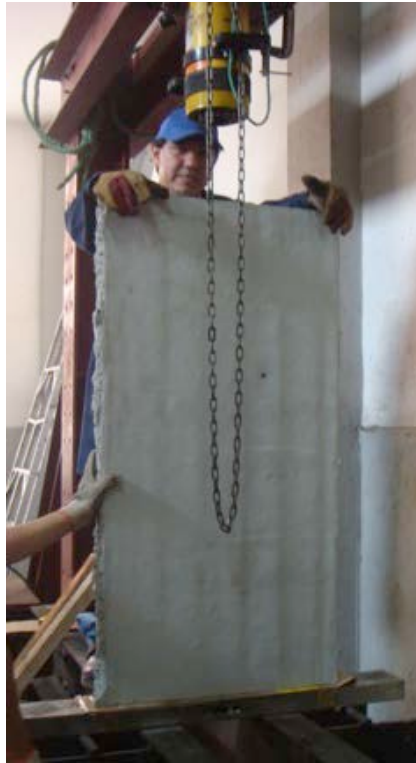
Ilustración 44: Panel para ensayo de compresión
