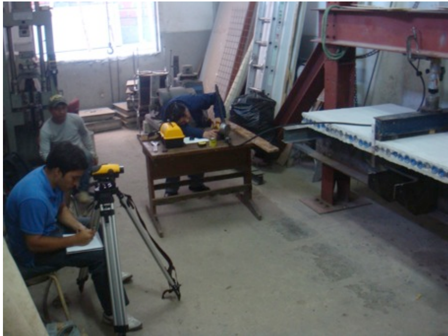
Ilustración 38: Nivel para medir deformaciones
