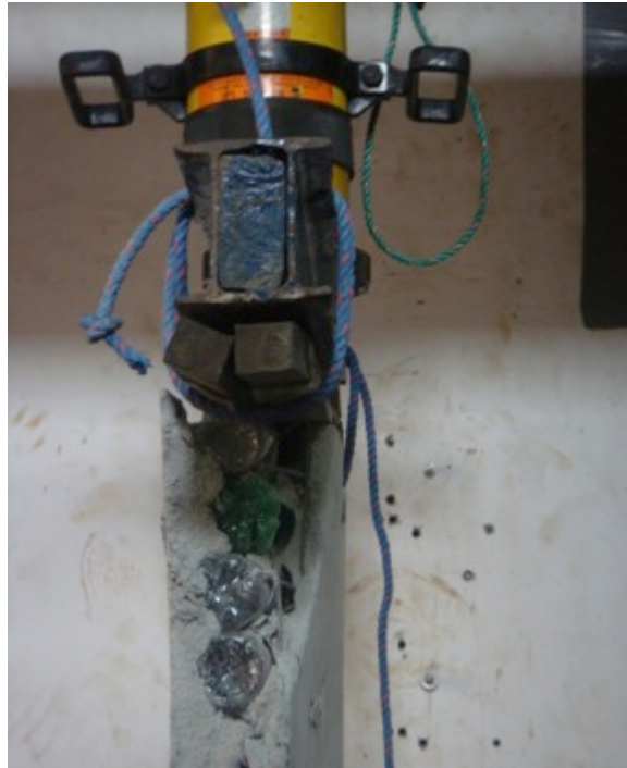
Ilustración 48: Introducción del neopreno en el núcleo de botellas del panel
