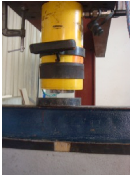
Ilustración 46: Gato hidráulico, disco, viga y neopreno
