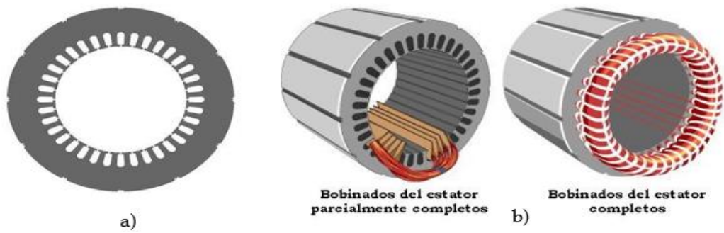
Figura 2. 8 Acoplamiento de estator en motor AC trifásico de inducción
