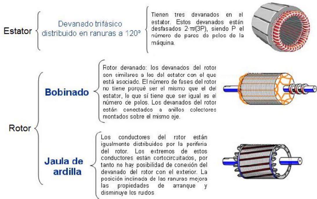
Figura 2. 11 Resumen de partes principales del motor asíncrono
