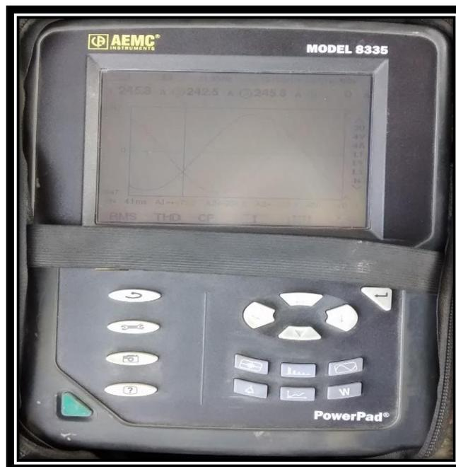
*Figura 2. 16. Analizador de redes eléctrico AEMC 8335
