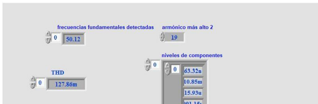
Figura 3. 10: Medición del espectro FFT de corriente, distorsión armónica, amplitud y nivel para la fase Y. Elaborado por: Autor.
