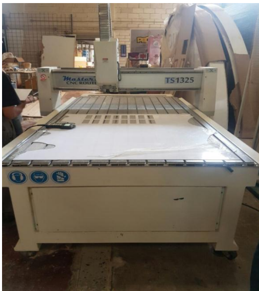
Foto 2.2: CNC ROUTER TS 1325 con 3 KW / 4 Hp Mesa de Trabajo principal Fuente: (El Autor, 2019)
