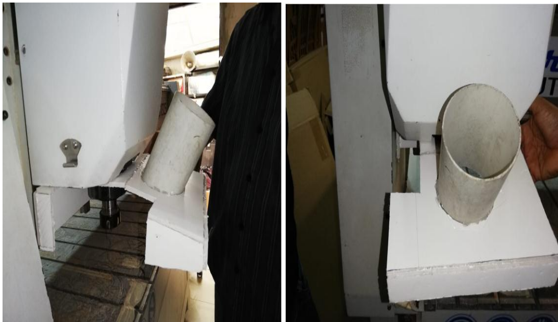
Foto 4.1: Recolector de polvo adaptado por Peopé Fuente: (El Autor, 2019)
