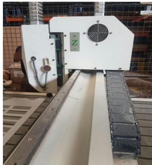
Foto 2.2: CNC ROUTER TS 1325 con 3 KW / 4 Hp Mesa de Trabajo principal Fuente: (El Autor, 2019)
