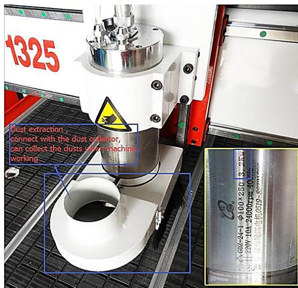
Figura 4.1 Extractor acoplado a Router CNC 1325 Fuente: (ShanDong, 2019)
