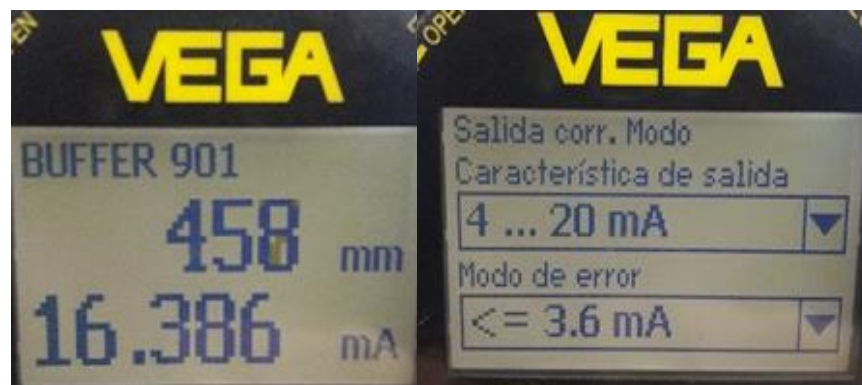
Figura 40: Realizando ajuste de salida de corriente. Fuente: Autor
