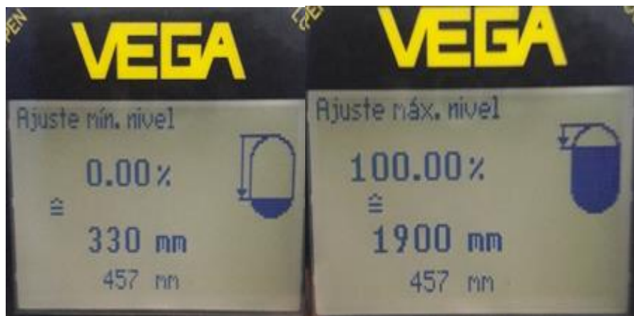
Figura 39: Realizando ajuste de parámetros de alto y bajo nivel. Fuente: Autor
