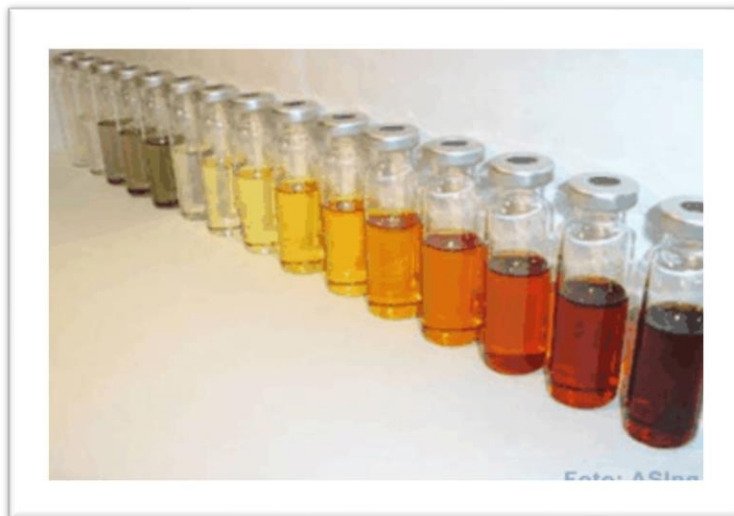
Figura 2.22. Degradación del aceite dieléctrico de un transformador Fuente: IMSE (2016).
