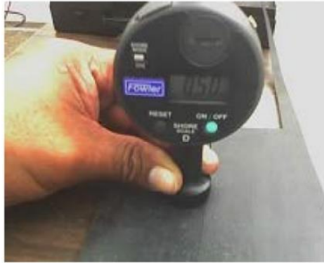
Figura 6.2. Medición de dureza shore en caucho. Imagen tomada de (Correa Manosalvas, 2011).
