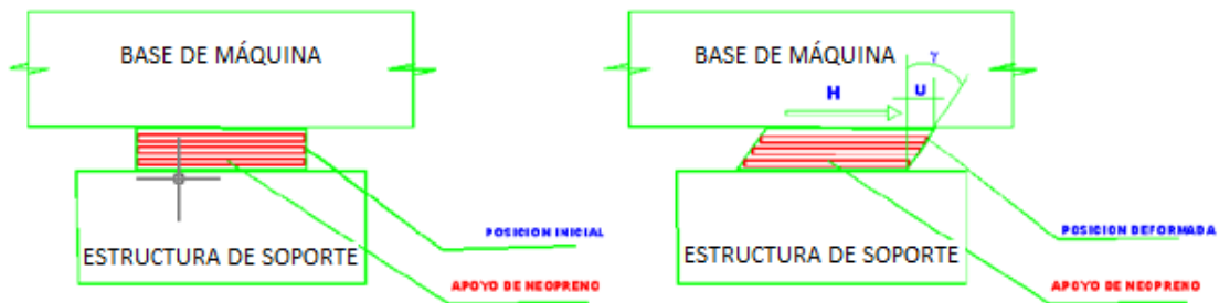
Figura 6.1. Comportamiento del apoyo de neopreno bajo la aplicación de una fuerza horizontal. (Correa Manosalvas, 2011)
