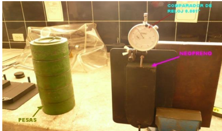
Figura 6.16. Equipo utilizado para ensayo de corte. Imagen tomada de (Correa Manosalvas, 2011).
