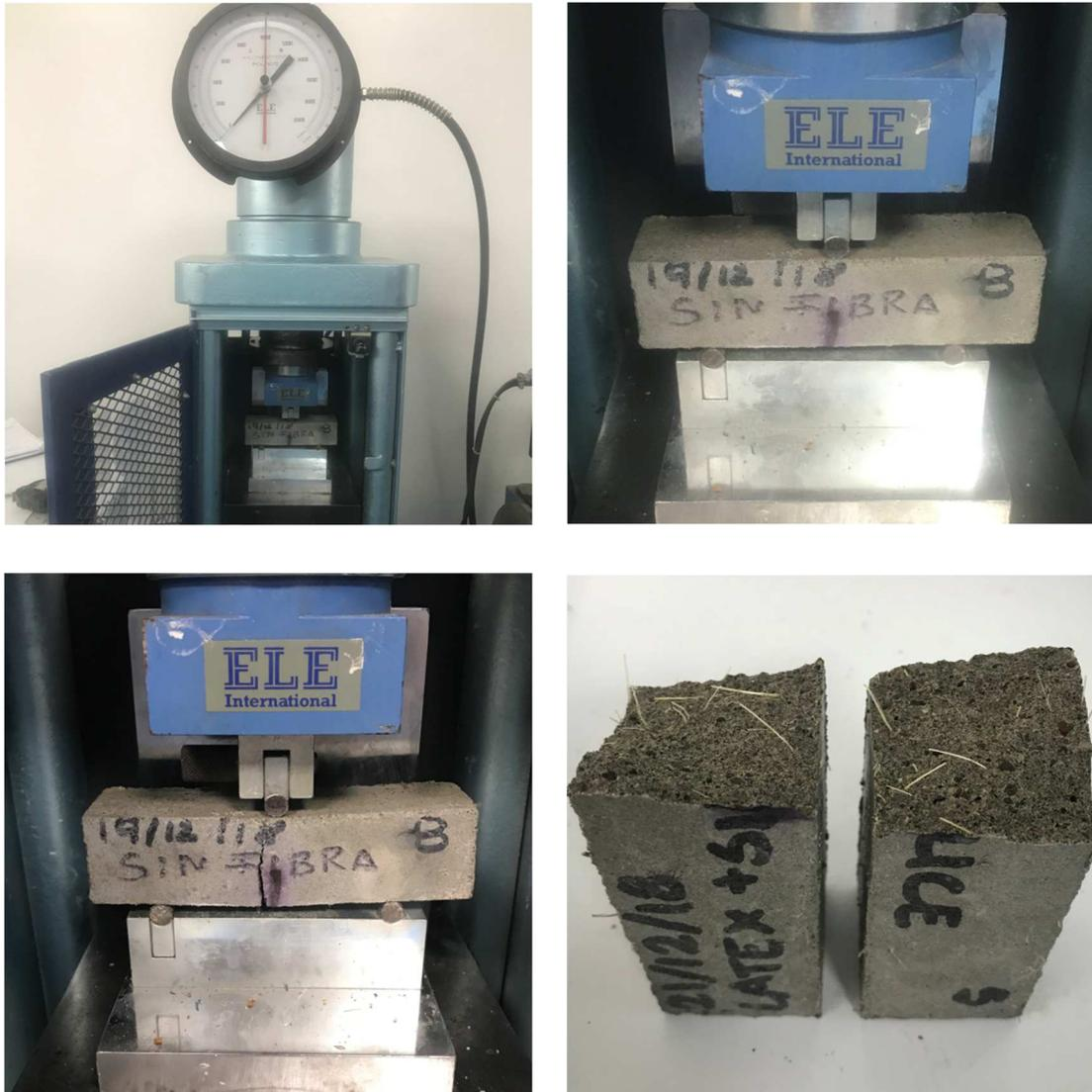
**Ilustración 17. Procedimiento del ensayo de flexión.**
