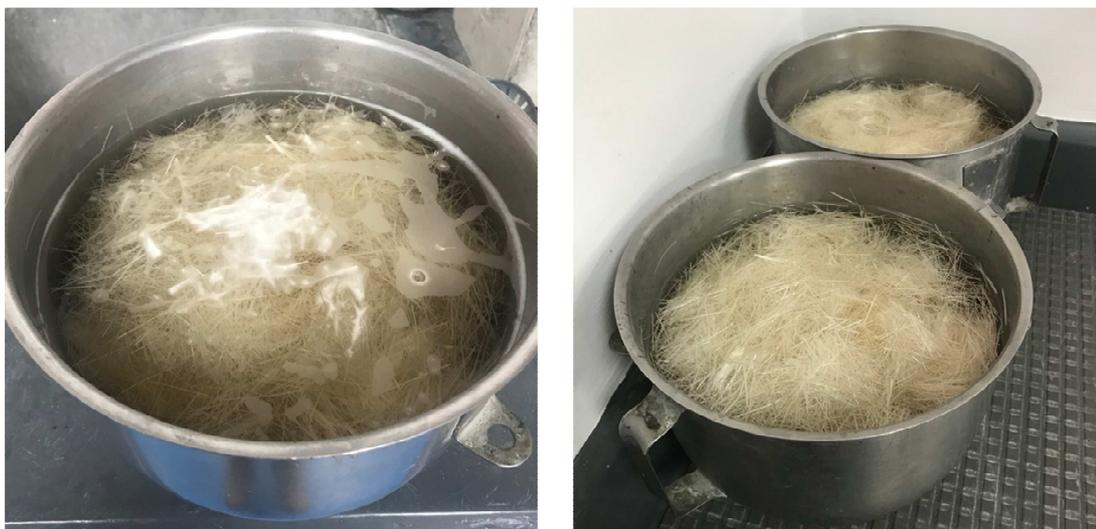
**Ilustración 5. Procedimiento del tratamiento 3: hornificación.**
