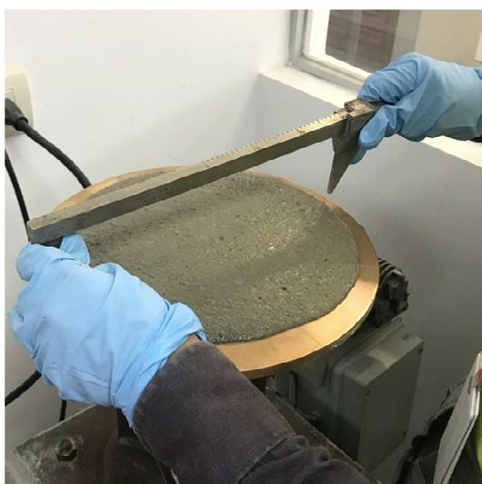
**Ilustración 12. Procedimiento del ensayo de flujo.**
