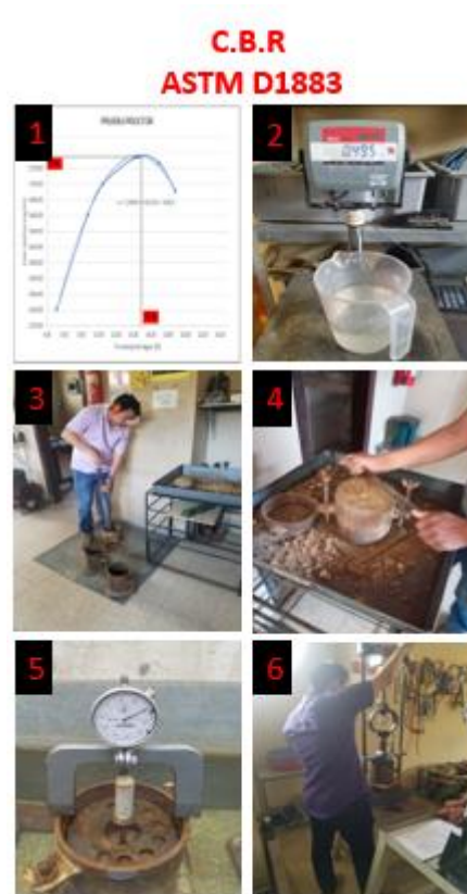
Ilustración 27 Proceso para ensayo de Proctor Modificado bajo la norma ASTM D1883
