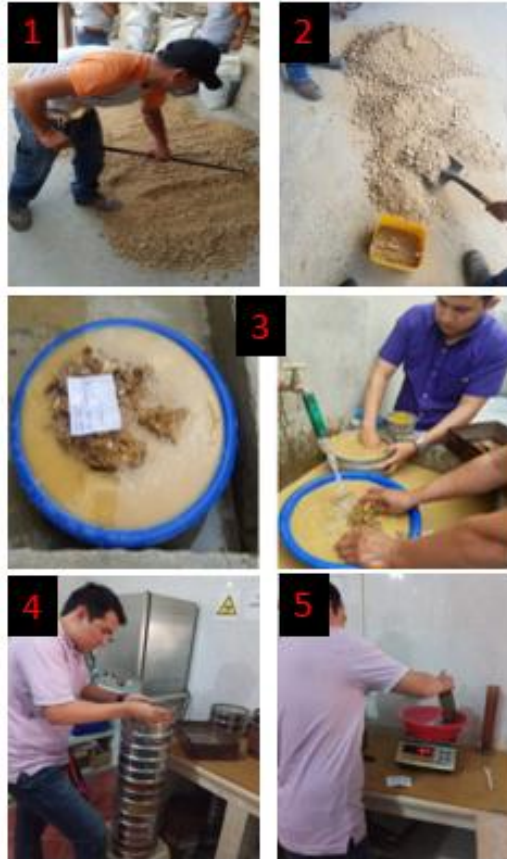
Ilustración 13 Proceso para ensayo de Granulometría bajo la norma ASTM D422
