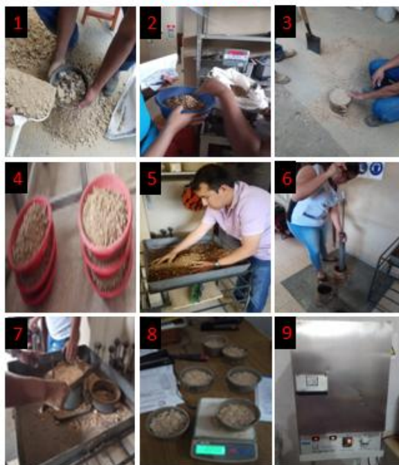
Ilustración 25 Proceso para ensayo de Proctor Modificado bajo la norma ASTM D1557
