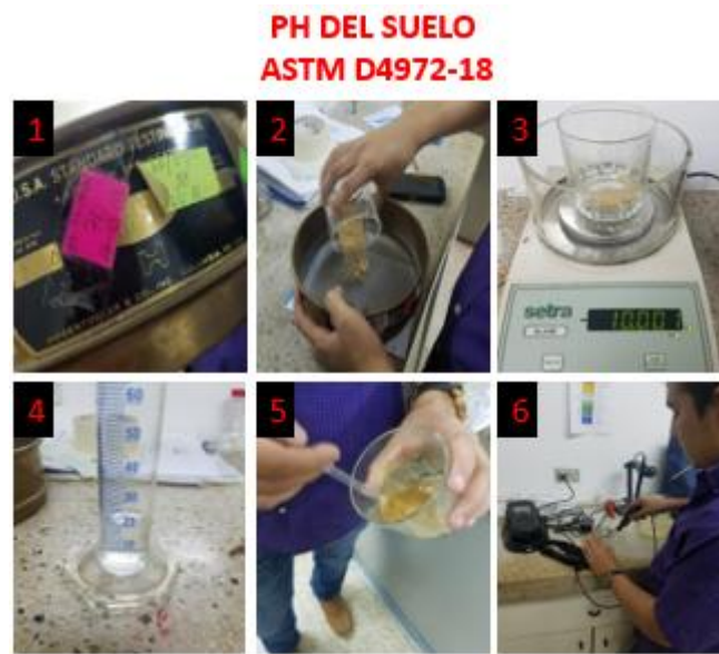
Ilustración 31 Proceso para ensayo del PH bajo la norma ASTM D4972-18
