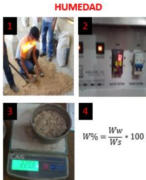
Ilustración 18 Proceso para ensayo de Humedad bajo la norma ASTM D2216
