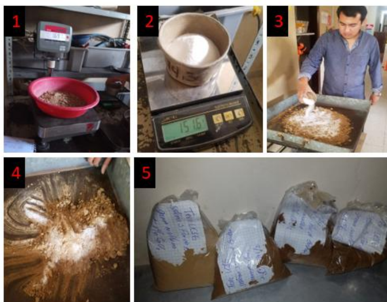
Ilustración 43 Preparación de las muestras con Cloruro de Calcio
