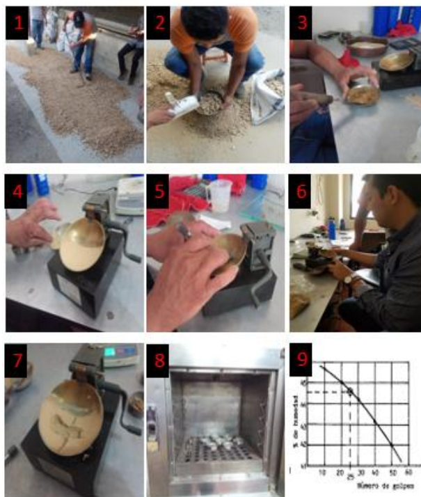
Ilustración 19 Proceso para ensayo de Límite Líquido bajo la norma ASTM D4318
