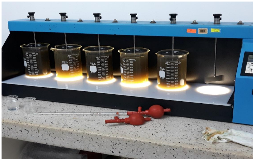
Ilustración 12 Prueba de jarras para determinar dosificación
