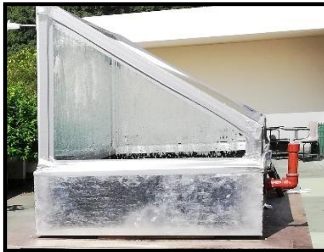
Ilustración 32: Evaporación de agua dentro del modelo purificador
