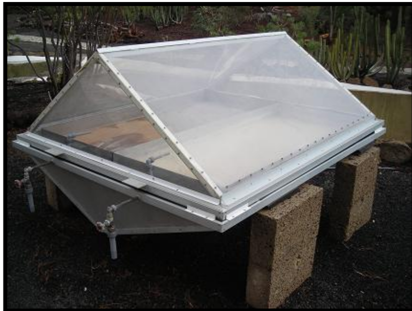
Ilustración 14: Purificador solar de dos Vertientes
