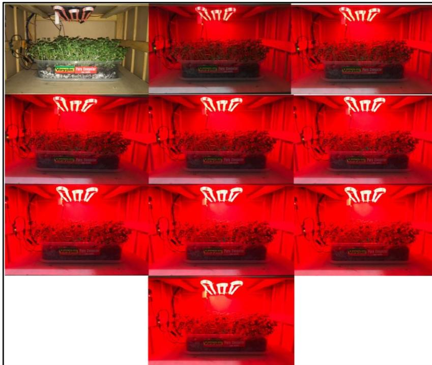
Figura 63. Pruebas de variación de la intensidad de luz emitida por los paneles.
