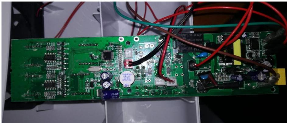
**Figura 4. 16.** Conexión de los diferentes componentes en la tarjeta controladora
