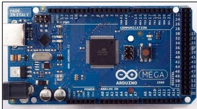
Figura 2. 15. Imagen de referencia de un Arduino Mega 2560
