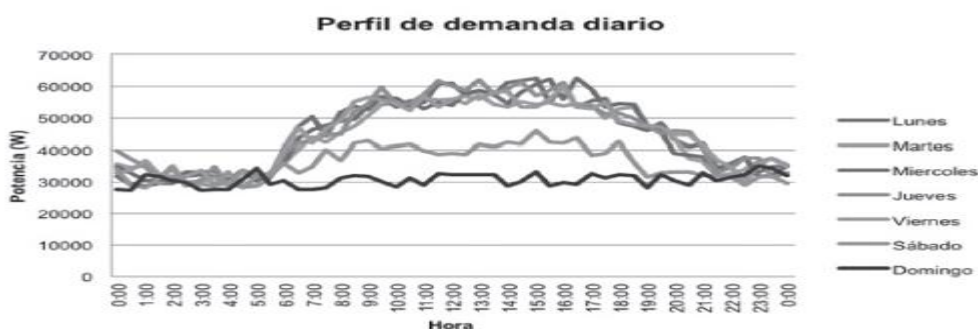
Ilustración 3. Perfil de consumo de energía eléctrica residencial.
