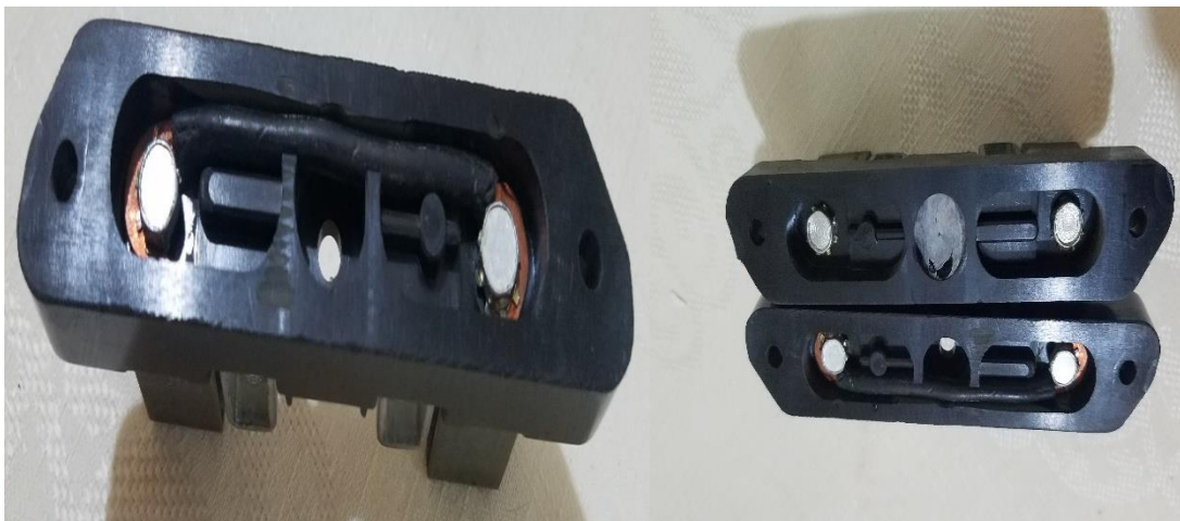
Ilustración 20. Puente interno en baquelita.
