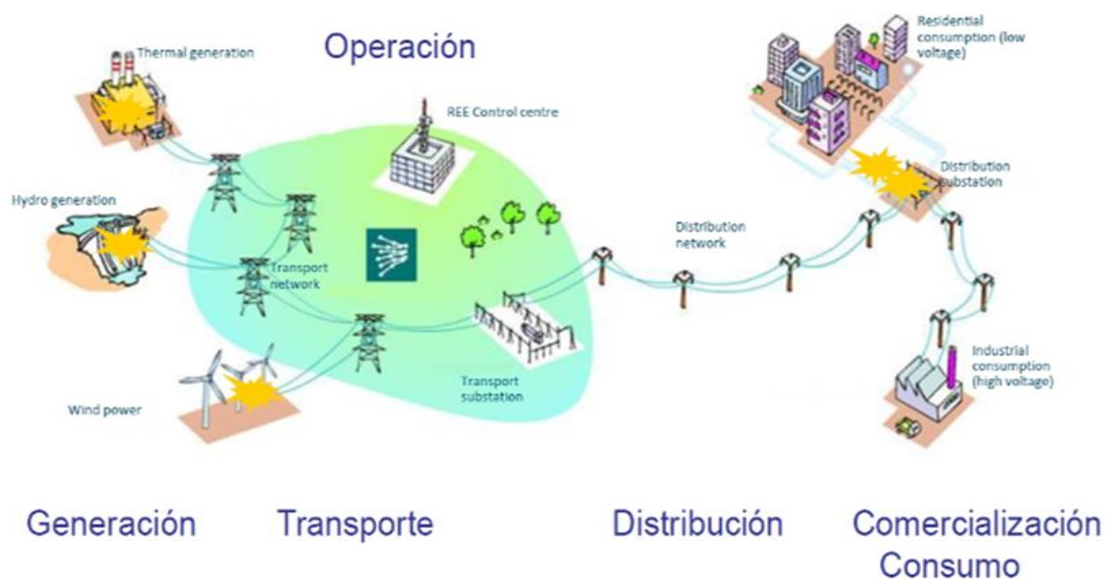
Ilustración 1. Sistema de energía eléctrica.
