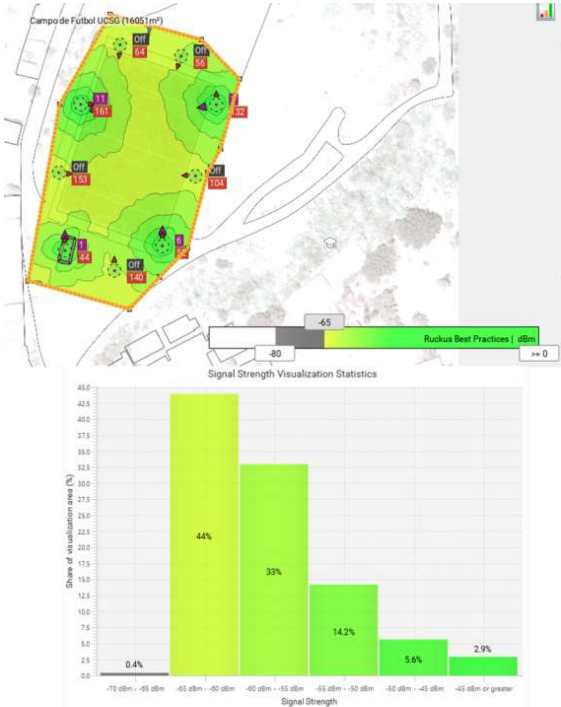
Figura 3. 28 Intensidad de la señal, en 2.4GHz Elaborado por: Autor
