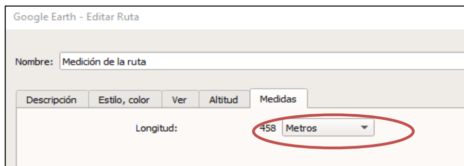
Figura 3. 7 Distancia aproximada del tendido del enlace de fibra. Elaborado por: Autor
