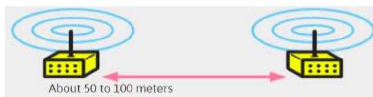
Figura 2. 21 Distancia optima entre dispositivos. Fuente: (Commotion Wireless, 2015)
