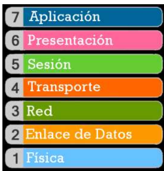
Figura 2. 3 Capas del modelo OSI. Fuente: (Barbosa, 2015)
