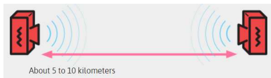
Figura 2. 22 Distancia optima entre enrutadores de gama alta. Fuente: (Commotion Wireless, 2015)
