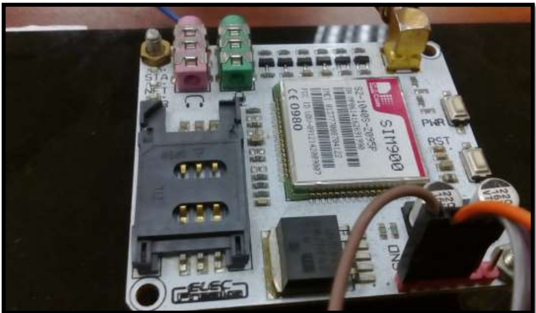
Foto N° 2: Modulo GSM SIM900
