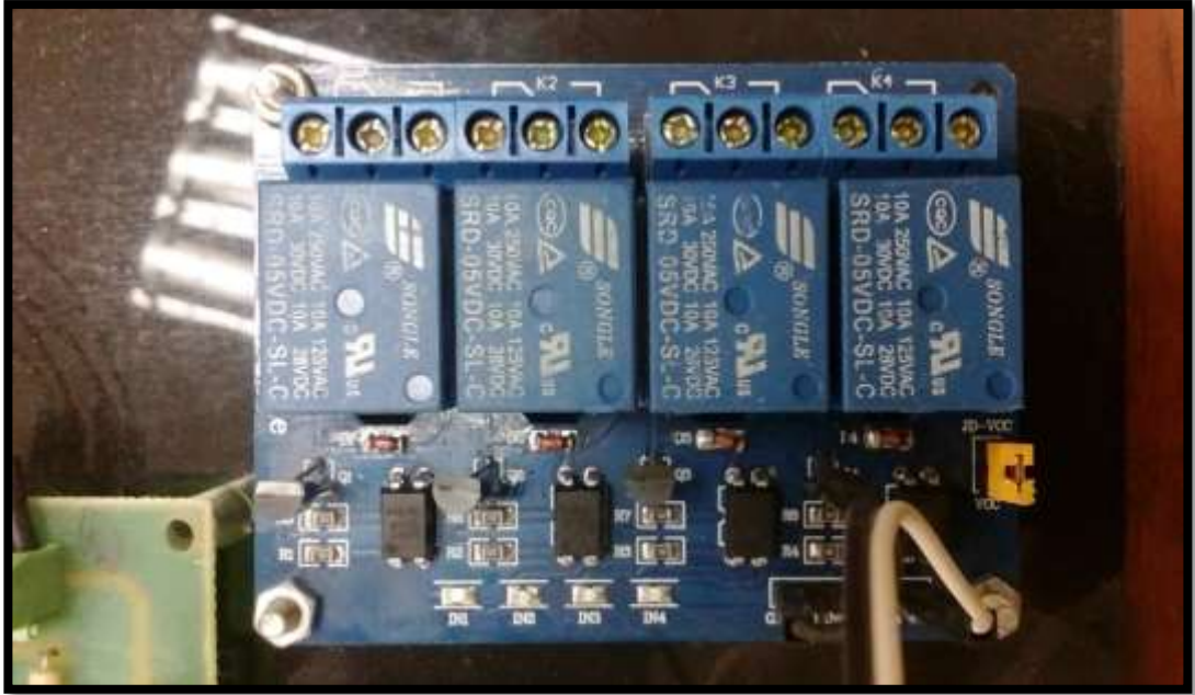
Foto N° 7: Módulo de relé para etapa de fuerza
