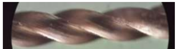
Gráfico 4: Observación representativa del grupo de lima k marca kendo #15, vista en microscopio óptico 10x.
