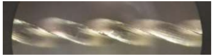
Gráfico 6: Observación representante del grupo de lima k marca kendo #20, vista en microscopio óptico 10x.
