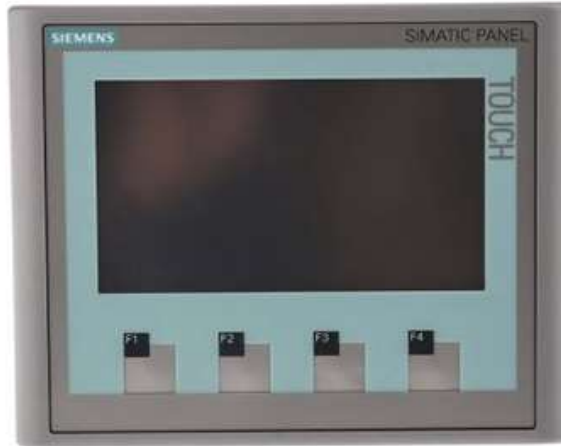
Figura 2. 7 HMI (Interface hombre- máquina)
