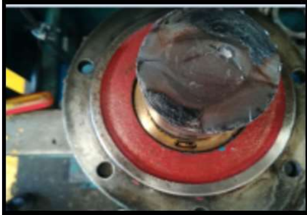
Figura 4. 9 Eje de bomba roto Fuente. El autor
