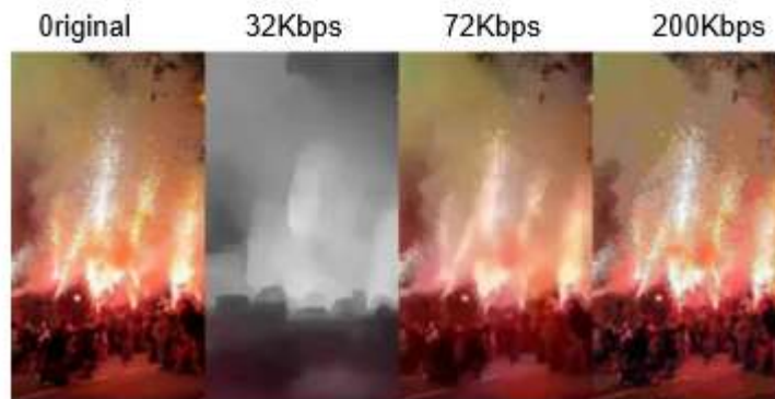
Figura 2. 2: Efecto de la compresión de vídeo MPEG-4 sobre la calidad de imagen percibida.
