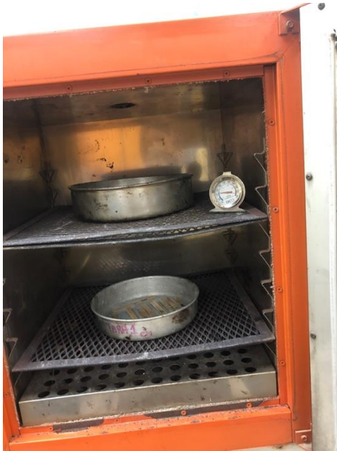
Figura 13: Colocación de las tirillas de fibra de caña guadúa en el horno a una temperatura de \pm 105\text{ }^{\circ}\text{C} .
