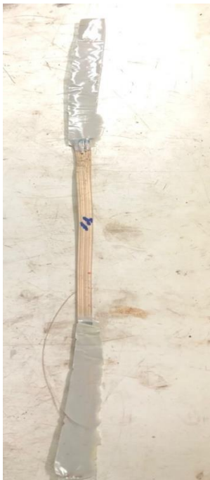
Figura 9: Tirilla de fibra de caña guadúa en sus extremos con epóxico para mejorar el agarre de las fibras
