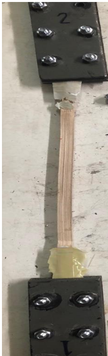
Figura 10: vista de la tirilla colocada en las placas de acero con una superficie libre sin epóxico de 20 cm.
