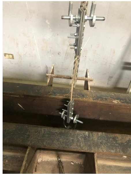
Figura 5: Colocación del sistema de placas en el pórtico para la determinación de la fuerza última de la fibra con la ayuda de la balanza.
