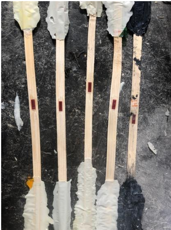
Figura 16: Galgas extensiométricas localizadas en el centro de las tirillas de fibra de caña guadúa.
