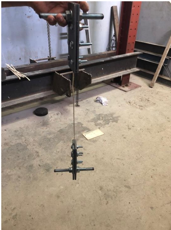
Figura 4: Sistema creado con placas de acero y pernos para ajustar la fibra.
