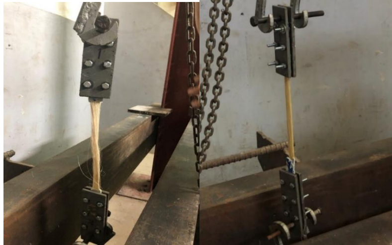
Ilustración 9. Sistema de poleas y placas de ensayo a tracción.
