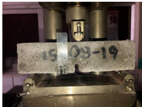
Ilustración 36. Probeta ha llegado a la fractura.
