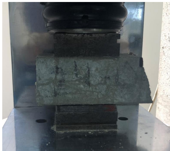
Ilustración 28. Ensayo a Compresión, semiprisma ha llegado a falla.
