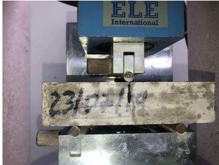
Ilustración 27. Ensayo a Flexión, probeta han llegado a falla.
