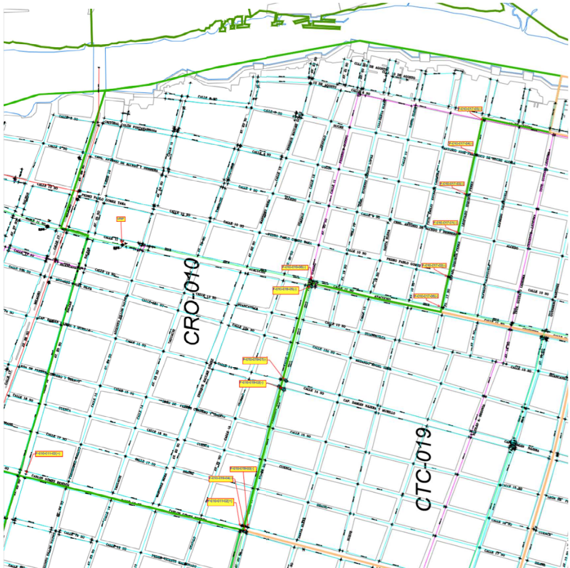
Figura 7. Ubicación de válvula de frontera y VRP del sector CRO-010
