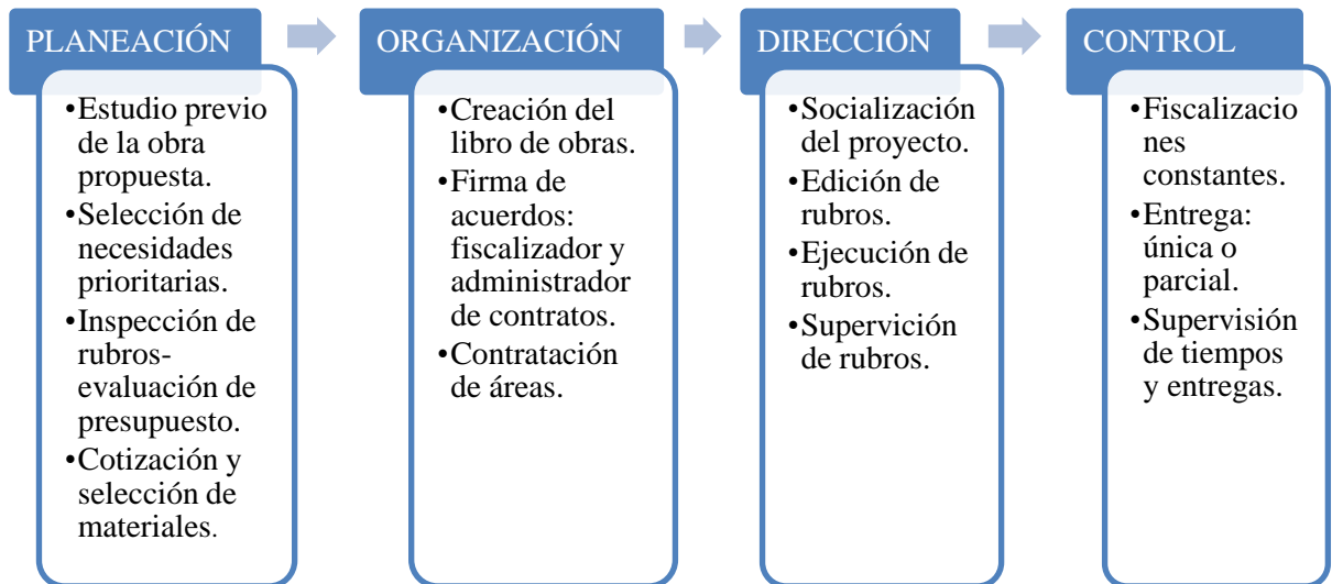
Figura 4. Procesos en proyecto de construcción. Elaboración propia.
