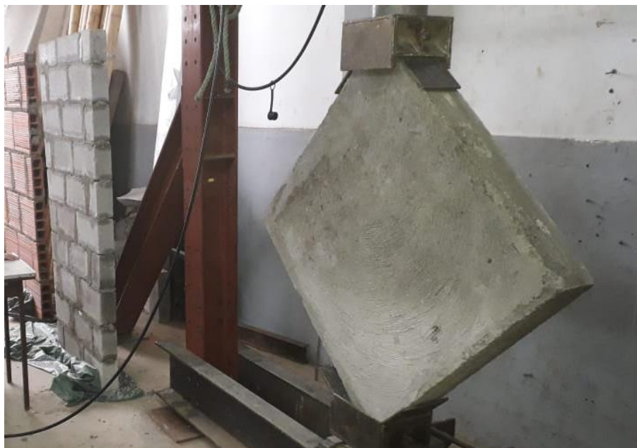
Ilustración 19. Ensayo de resistencia a la compresión de la mampostería (f'm).
