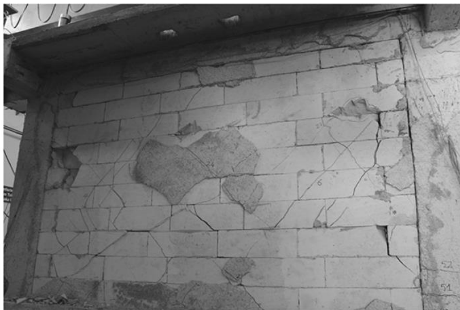
Ilustración 29. Muestra de fisuras en PRM con bloques de hormigón AAC Fuente: (Misir, Ozcelik, Girgin, & Yucel, 2016)
