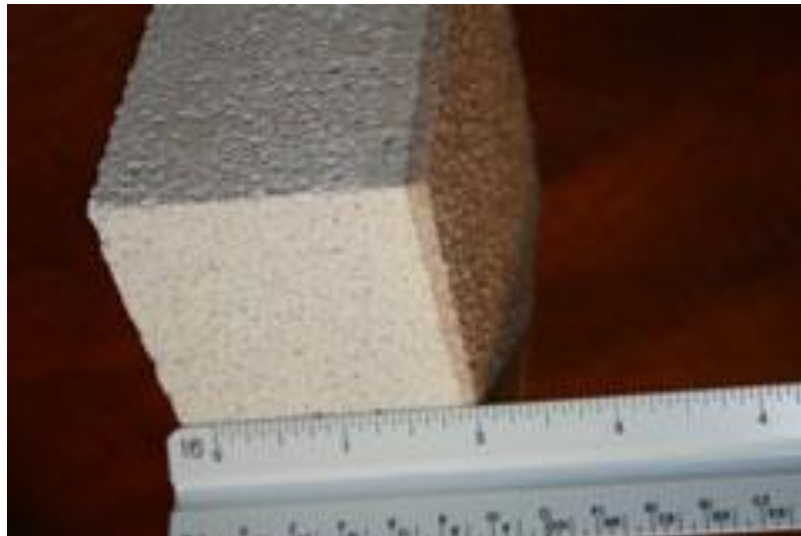
Ilustración 17. Los acabados tipo stucco están hechos específicamente para AAC. Fuente: (“Autoclaved Aerated Concrete,” n.d.)
