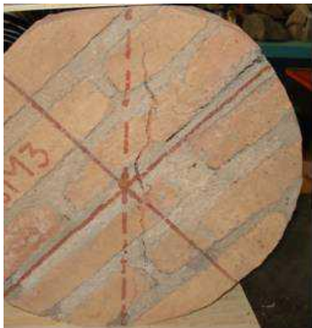
Ilustración 18. Falla de especímenes de mampostería circular, a) por grietas diagonales de la mampostería, b) por deslizamiento de la articulación. Fuente: (Id, 2010)
