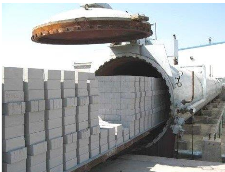
Ilustración 14. Los bloques de cemento – cal ingresando en el proceso de “autoclave”. Fuente: (“Calcium Silicate Bricks or Sand Lime Bricks for Masonry Construction,” n.d.)
