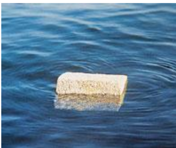
Ilustración 15. Autoclaved Aerated Concrete es lo suficientemente ligero como para flotar en agua. Fuente: (“Autoclaved Aerated Concrete,” n.d.)
