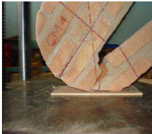
Ilustración 18. Falla de especímenes de mampostería circular, a) por grietas diagonales de la mampostería, b) por deslizamiento de la articulación. Fuente: (Id, 2010)
