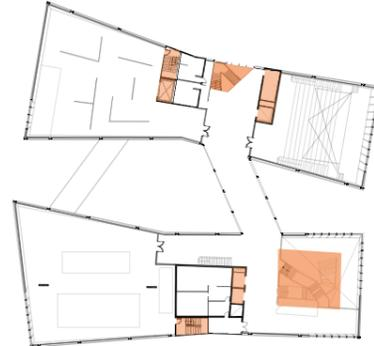
Las escaleras y la rampa son los principales elementos que el proyecto tiene, además cuenta con ascensores, montacarga y escaleras de emergencia.
