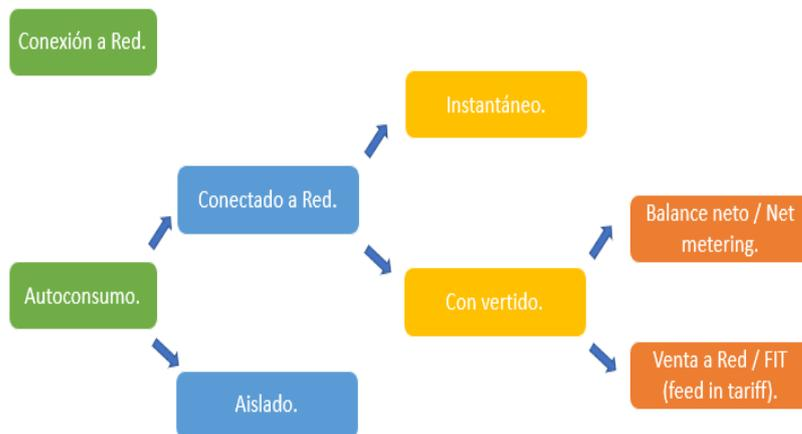
Figura 2. 15 Clasificación de los sistemas fotovoltaicos.
