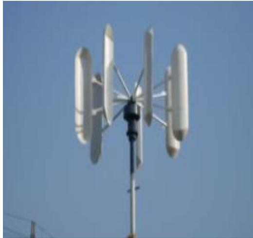
Figura 2. 9 Aerogenerador de tipo Giromill
