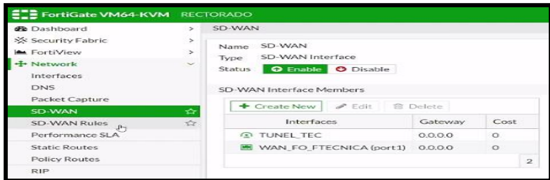
Figura 3.48 Interfaces creadas como miembro del enlace SD-WAN del equipo del laboratorio.
