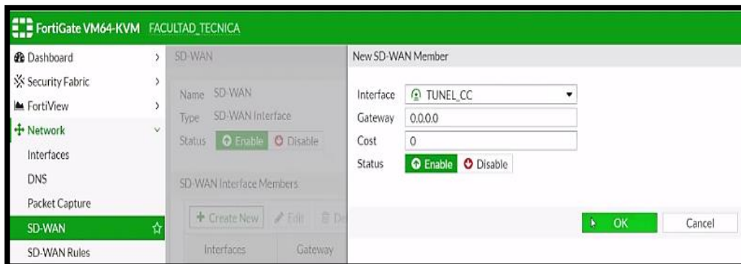
Figura 3.43 La interface TUNEL_CC como miembro del enlace SD-WAN. Elaborado por: Autor
