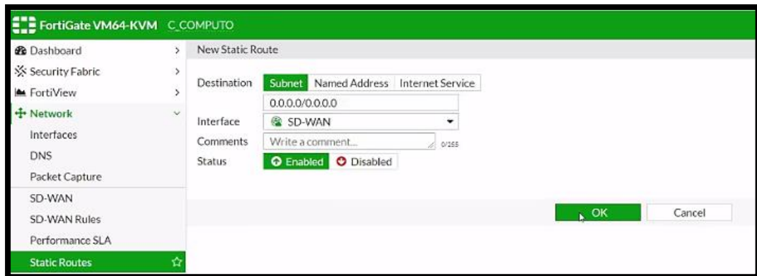
Figura 3.56 Creación de una ruta estática con SD-WAN en el equipo del centro de cómputo.
