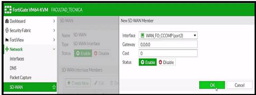
Figura 3.44 La interface WAN_FO_CCOMP como miembro del enlace SD-WAN. Elaborado por: Autor
