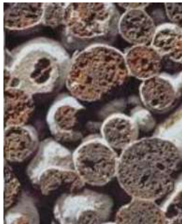
Figura 6. Partículas de hormigón sin finos. Fuente: González, 2018
