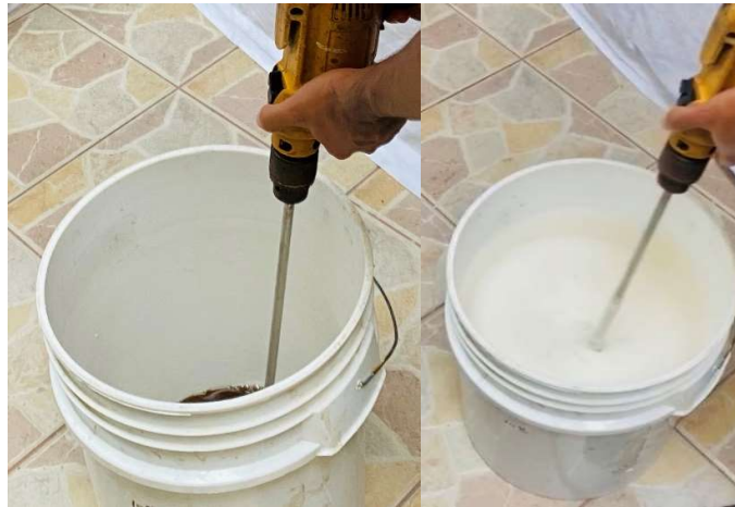
Figura 40. Formación de espuma con agitador de paletas. Fuente: Elaboración propia
