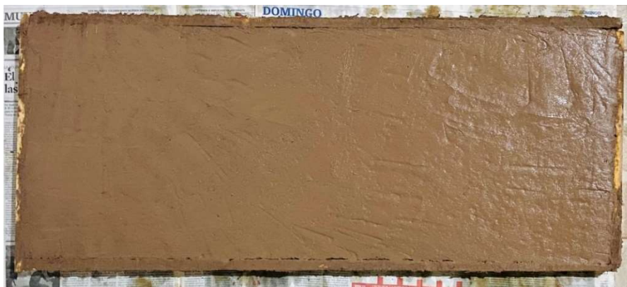
Figura 64. Plancha fundida en encofrado (1.0m x 0.4m x 0.04m) Fuente: Elaboración propia
