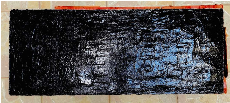
Figura 66. Plancha ultraliviana con harina de llanta reciclada. Fuente: Elaboración propia
