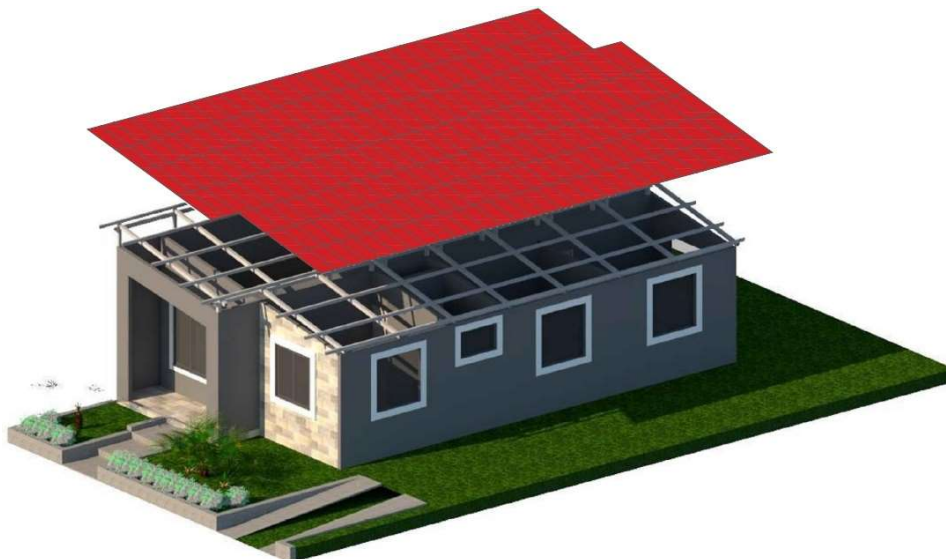
Figura 71. Vivienda social con planchas de hormigón ultraliviano. Fuente: Modificado de Silva, 2020
