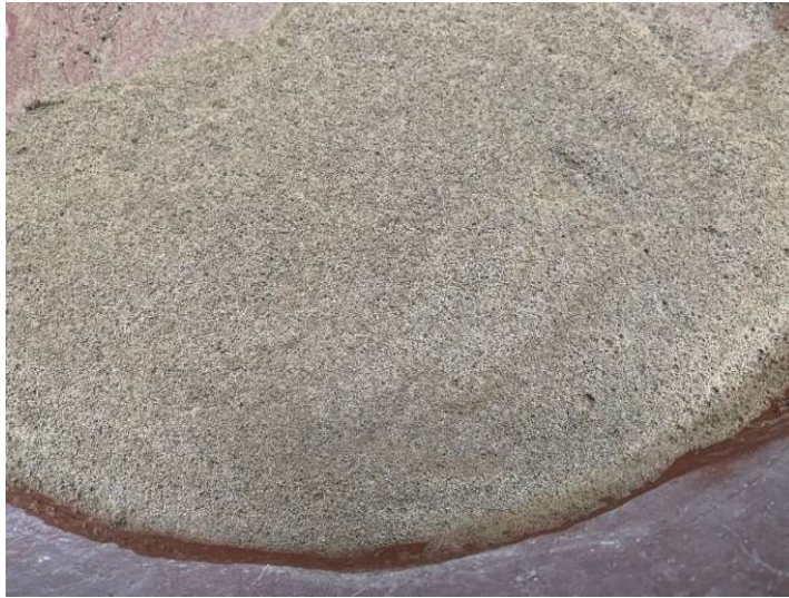
Figura 47. Mezcla de hormigón ultraliviano. Fuente: Elaboración propia
