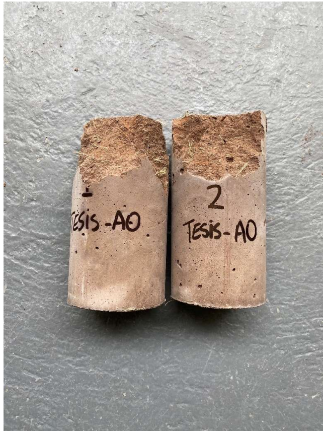
Figura 61. Ensayo de compresión simple realizado. Fuente: Elaboración propia
