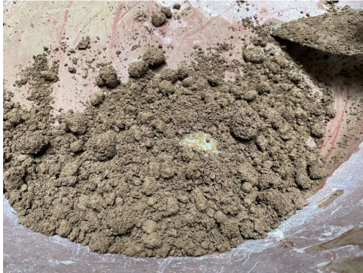
Figura 42. Adición de agua y aditivos hiperplastificantes a la mezcla. Fuente: Elaboración propia
