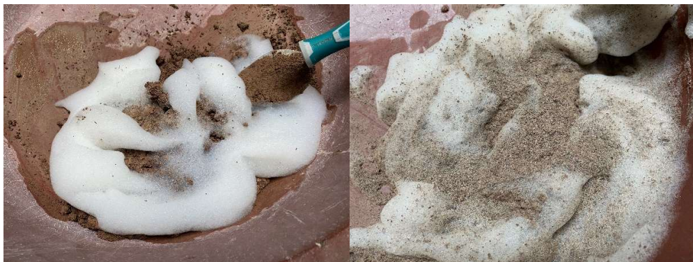
Figura 43. Adición de espuma a la mezcla. Fuente: Elaboración propia
