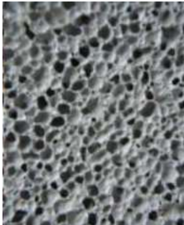
Figura 5. Composición de hormigón celular. Fuente: González, 2018
