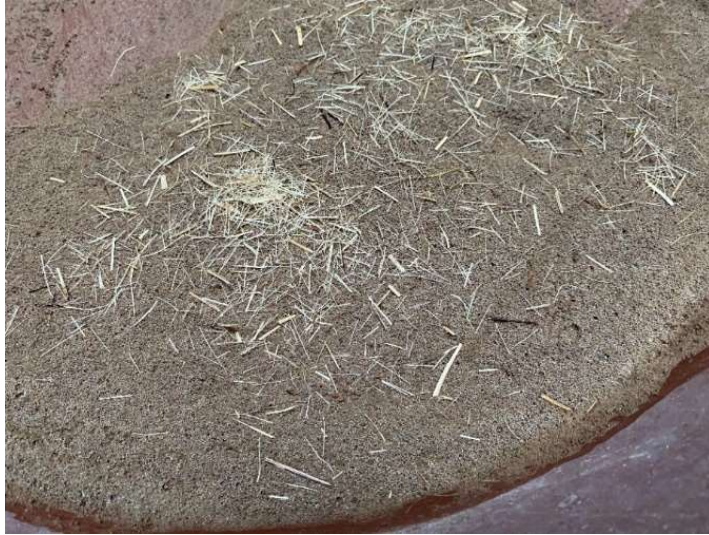
Figura 46. Adición de fibras de abacá (L=2cm) a la mezcla. Fuente: Elaboración propia
