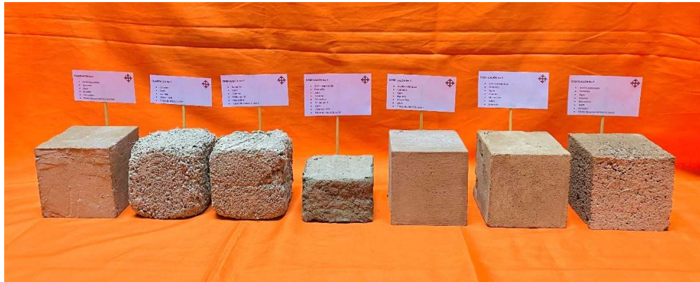
Figura 57. Cubos de hormigón ultraliviano con 7 dosificaciones diferentes. Fuente: Elaboración propia
