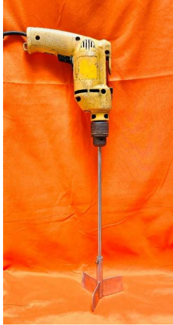
Figura 34. Agitador de paletas de laboratorio. Fuente: Elaboración propia
