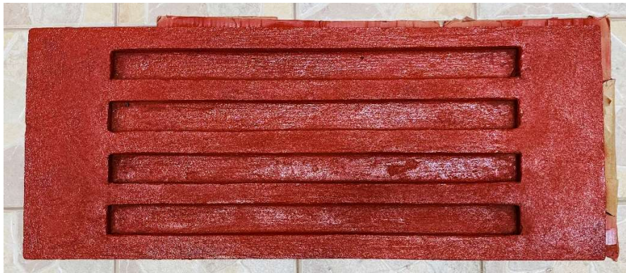
Figura 69. Plancha ultraliviana - Producto final (Vista inferior). Fuente: Elaboración propia
