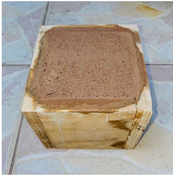
Figura 48. Hormigón ultraliviano fundido en molde de 10x10x10cm. Fuente: Elaboración propia
