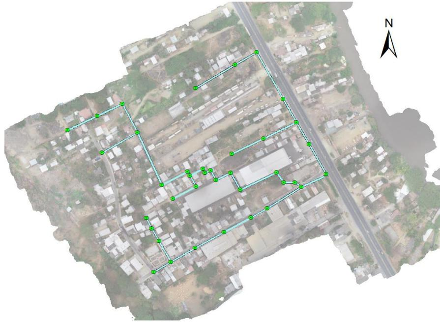
**Figura 21 Trazado de la Red de colectores**
