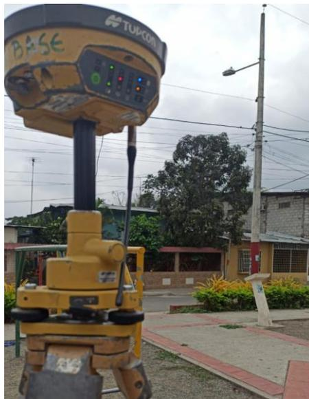
**Figura 18. Gps TopCom híper II usado para el levantamiento en Las Mercedes.**
