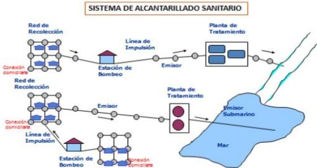
*Figura 1. Sistema típico de un sistema de alcantarillado sanitario*
