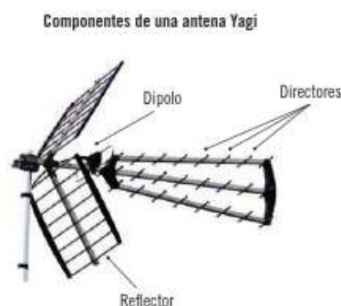
Figura # 2. 10 Componentes de una antena Yagi
